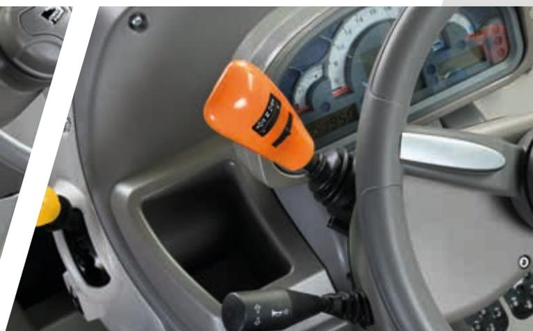
> PowerShuttle com 5 níveis de regulação SenseClutch.
