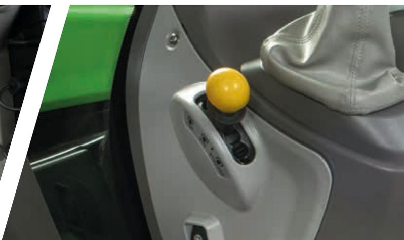
> Seletor de velocidade da tomada de força na cabina.
