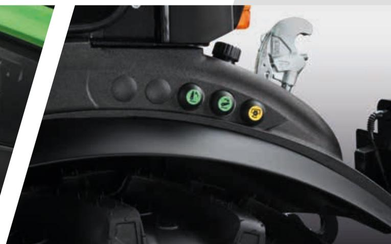
> Botões externos para o elevador traseiro e a tomada de força para facilitar as manobras de acoplamento.
