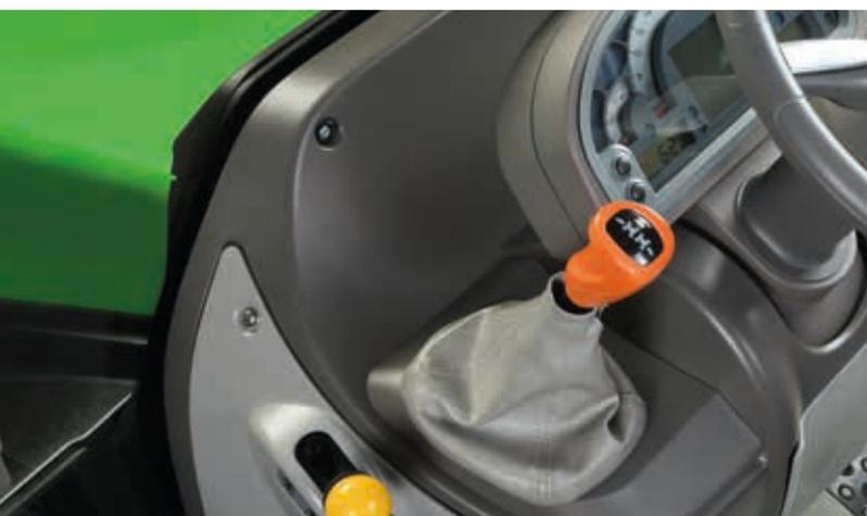
> Inversor mecânico com alavanca ergonómica na coluna de direção.
