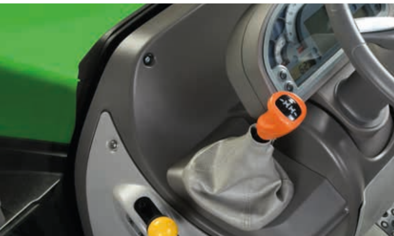
> Mechanisches Wendegetriebe mit ergonomischem Hebel an der Lenksäule.
