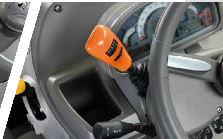
> PowerShuttle mit SenseClutch (5 Einstellstufen).
