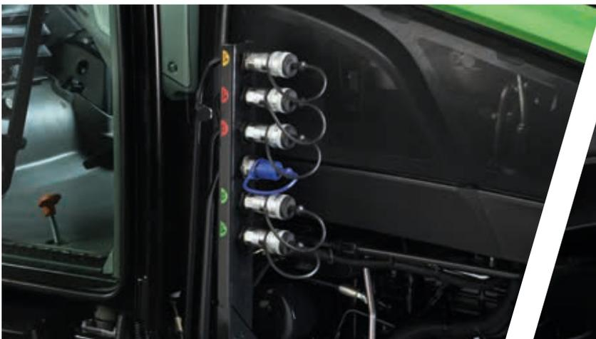
> Hasta 5 vías hidráulicas montadas en posición central.
