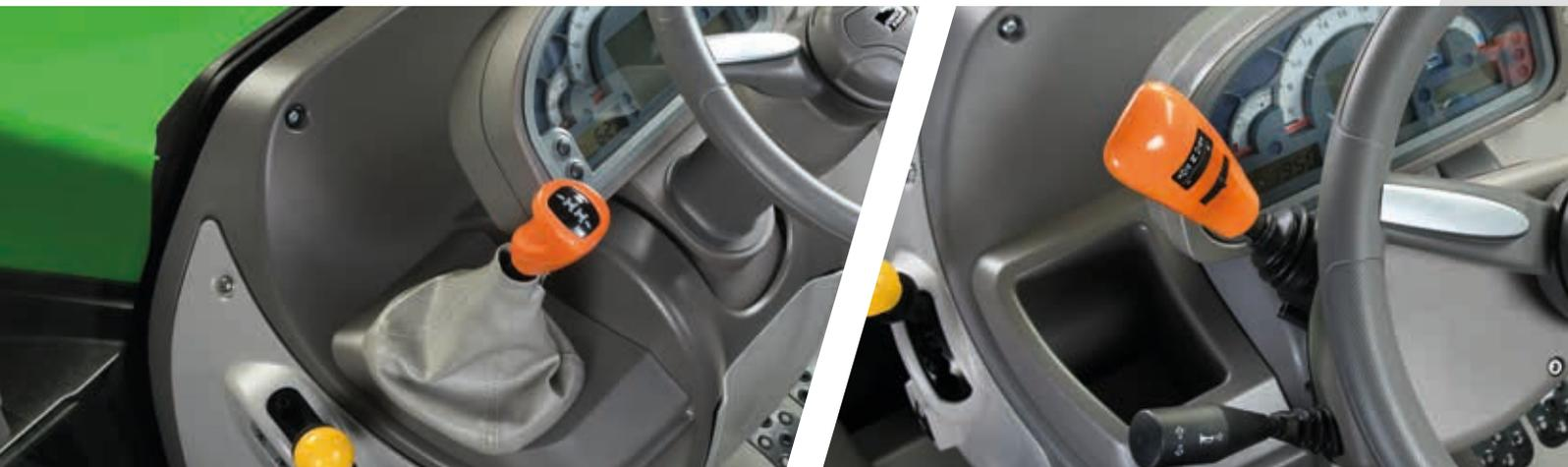
> Inversor mecánico con palanca ergonómica en la columna de dirección.
