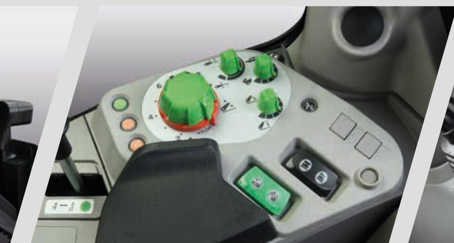
> Gran precisión del control de la tracción y de la posición gracias al elevador trasero electrónico.
