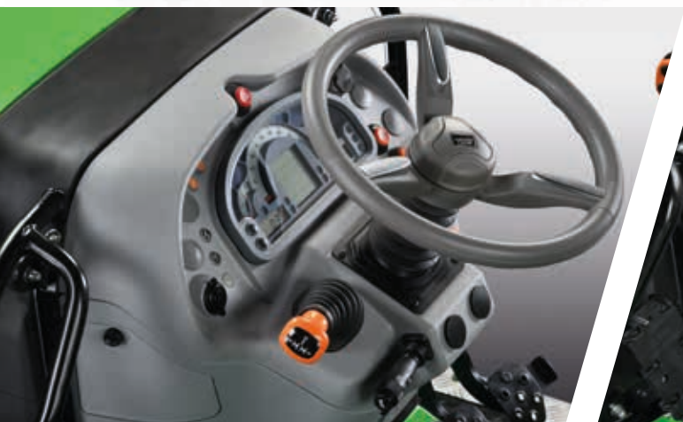
> Mechanische omkeerschakeling met ergonomische hendel op stuurkolom.
