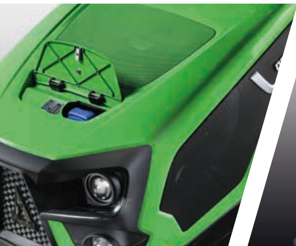
> Reservatório de AdBlue facilmente acessível.
