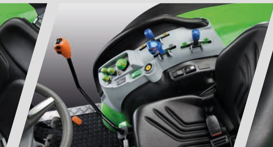
> Comandos eletrônicos confortáveis do elevador traseiro e do distribuidor.
