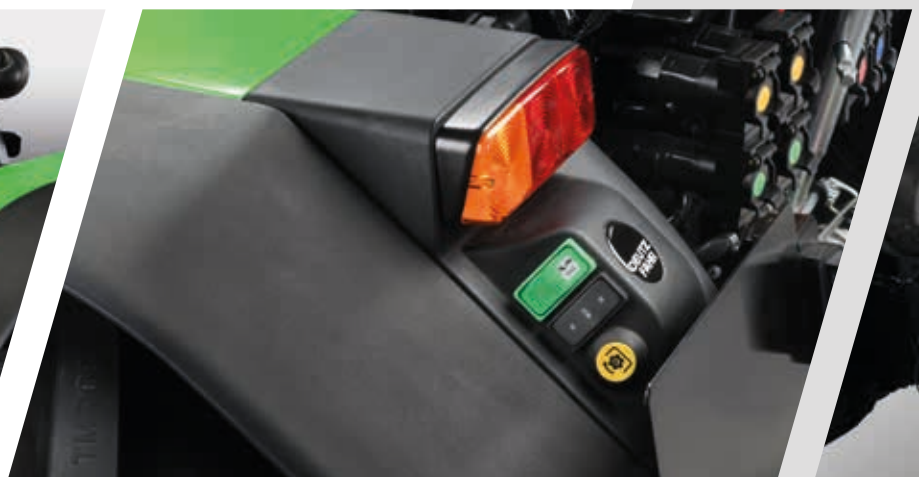
> Os botões de pressão externos para o elevador traseiro, a TDF traseira e os estabilizadores laterais simplificam as manobras de acoplamento.
