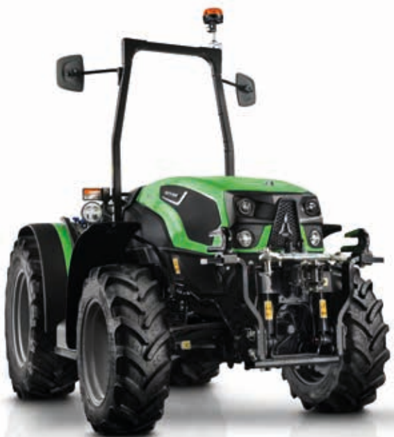
> Elevador frontal e TDF frontal totalmente integrados.
