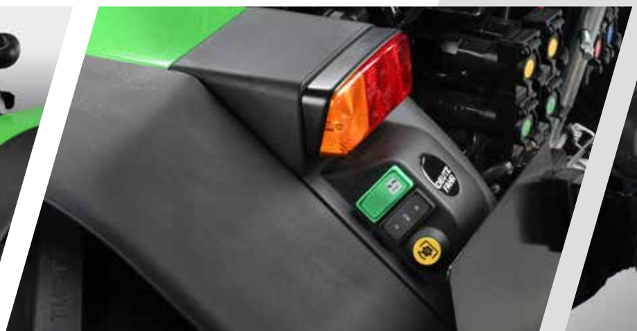
> Externe Drucktasten für den Heckkraftheber, die Heckzapfwelle und die Seitenstabilisatoren erleichtern das Ankuppeln.
