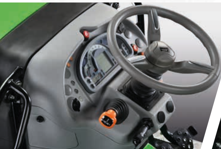
> Mechanisches Wendegeräte mit ergonomischem Hebel an der Lenksäule.
