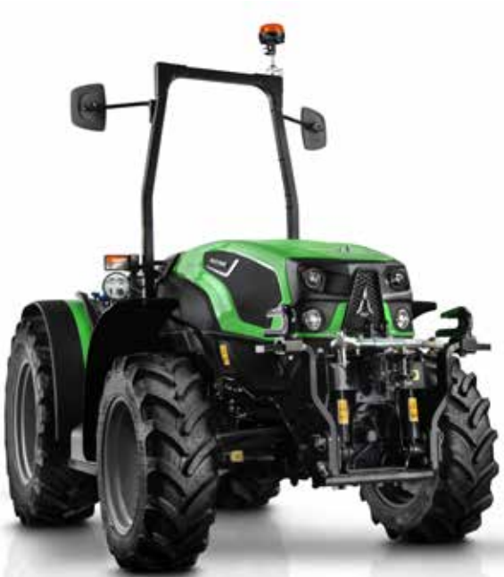
> Frontkraftheber und Frontzapfwelle vollständig integriert.
