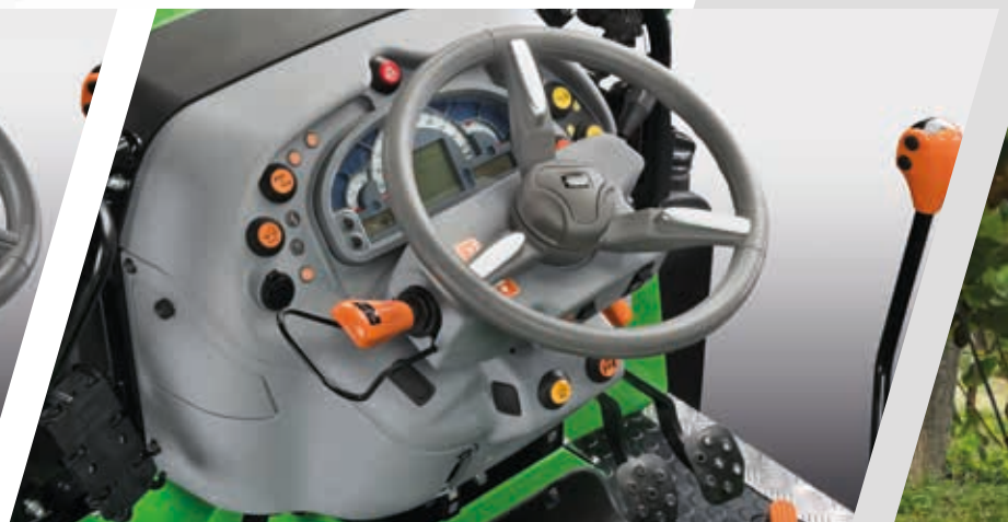
> PowerShuttle mit SenseClutch (5 Einstellstufen).
