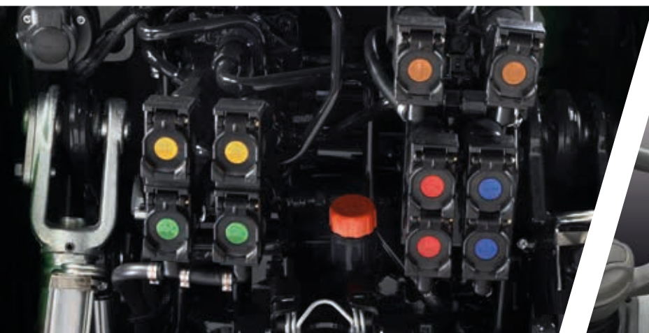
> Bis zu 5 Hecksteuergeräte.
