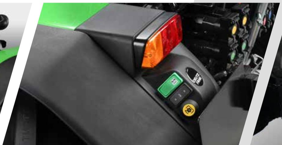
> Les boutons-poussoirs externes pour le relevage arrière, la prise de force arrière et les stabilisateurs latéraux simplifient les manœuvres d'attelage.
