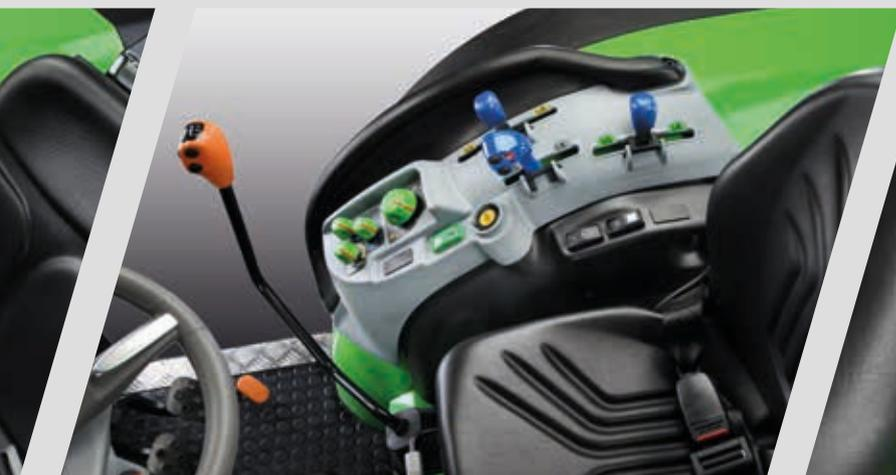
> Commandes électroniques confortables du relevage arrière et du distributeur.
