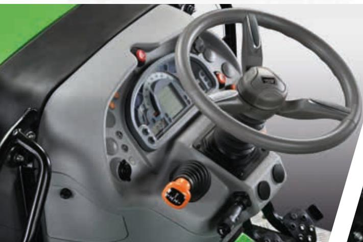
> Inverseur mécanique avec levier ergonomique sur la colonne de direction.
