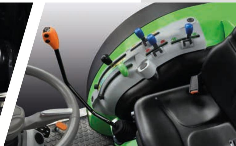
> Commandes mécaniques précises du relevage arrière et du distributeur.
