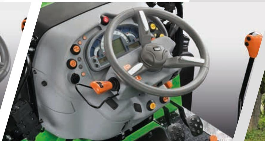
> Inverseur électrohydraulique PowerShuttle avec SenseClutch à 5 niveaux de réglage.
