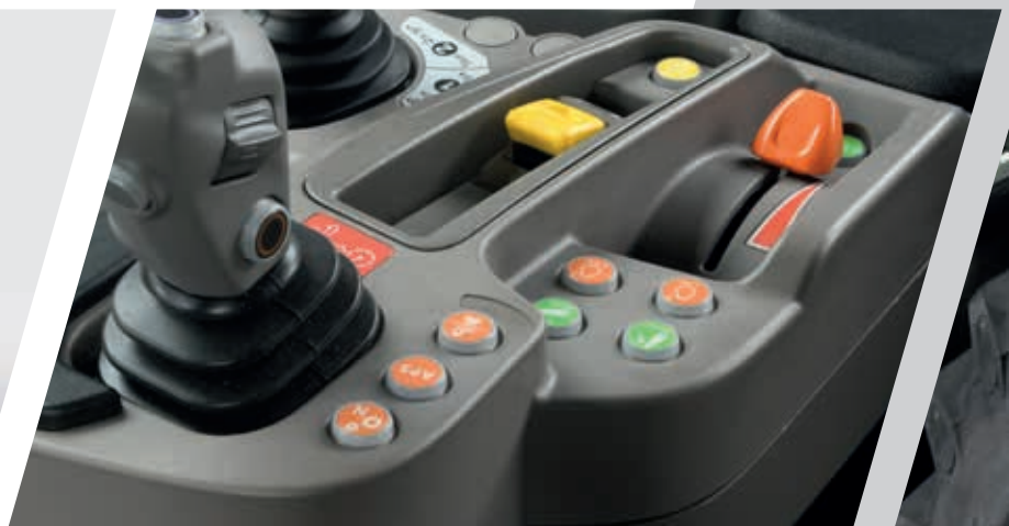
> Acelerador electrónico de mano con 2 memorias de régimen del motor.
