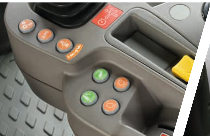
> Selección de modos de conducción Transporte, Campo, Reductora.
