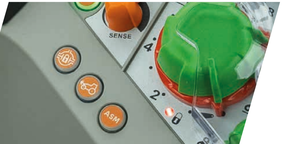
> Activación de APS con respuesta ajustable.
