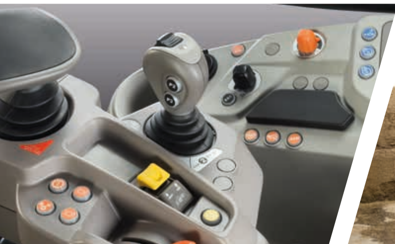
> Los joysticks programables, instalados de fábrica junto al asiento del conductor, ofrecen una ergonomía muy superior a la de cualquier solución posventa y te permiten controlar el elevador con facilidad y seguridad.
