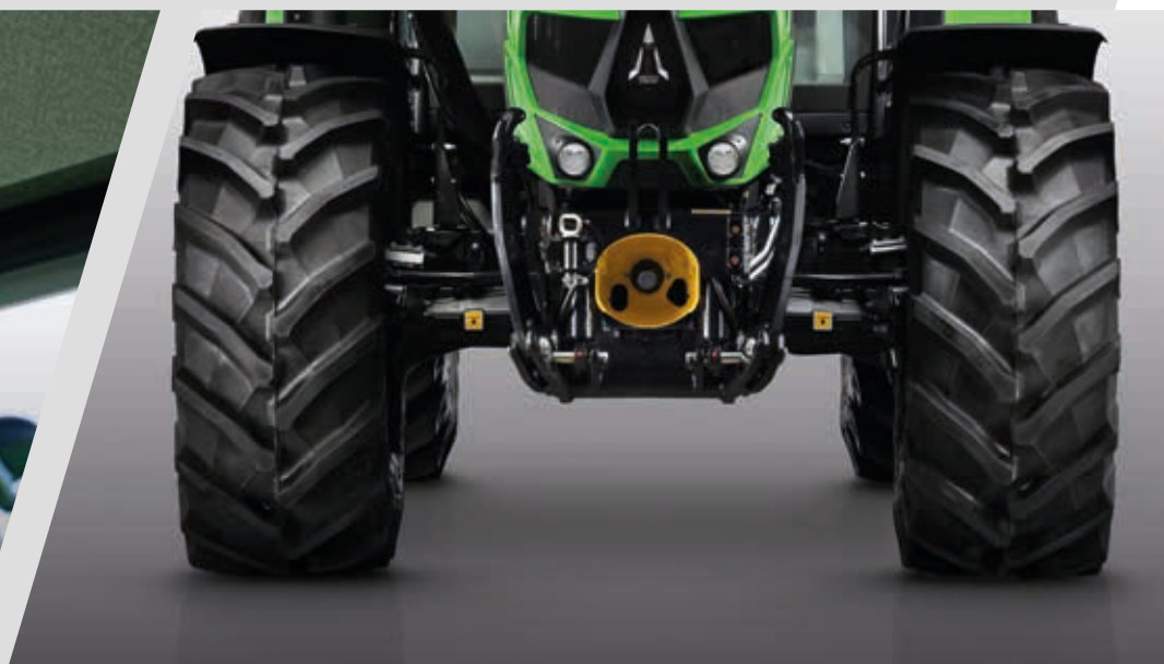
> Elevador delantero, TDF delantera y 2 salidas hidráulicas.
