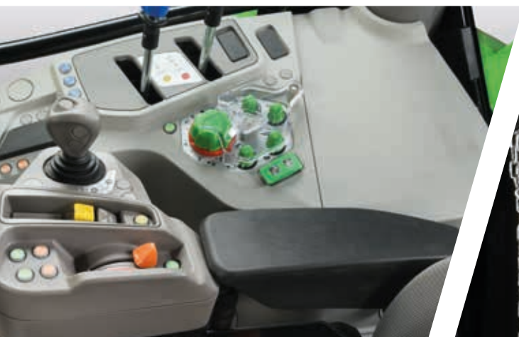
> Mandos hidráulicos mecánicos y electrónicos.
