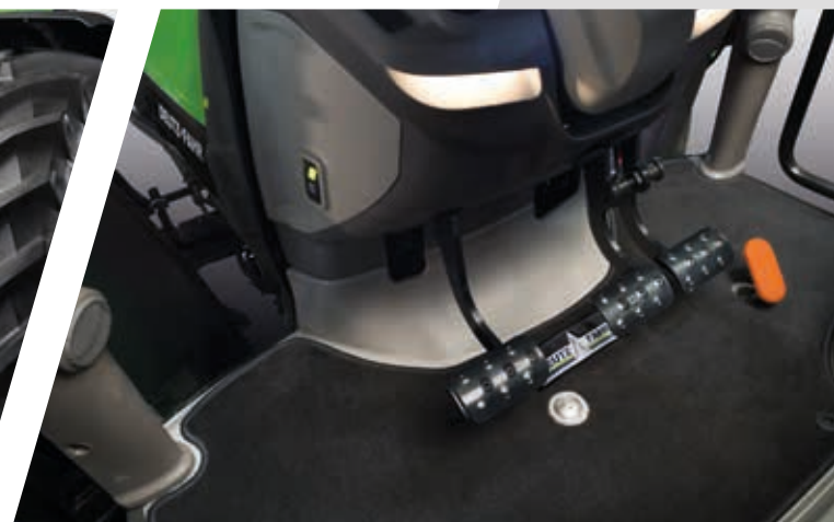
> Activación de freno motor hidráulico.
