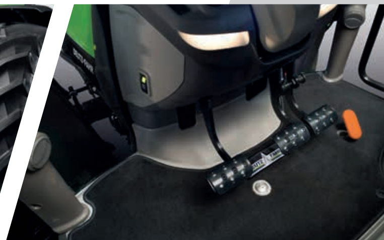
> Activation du frein moteur hydraulique.
