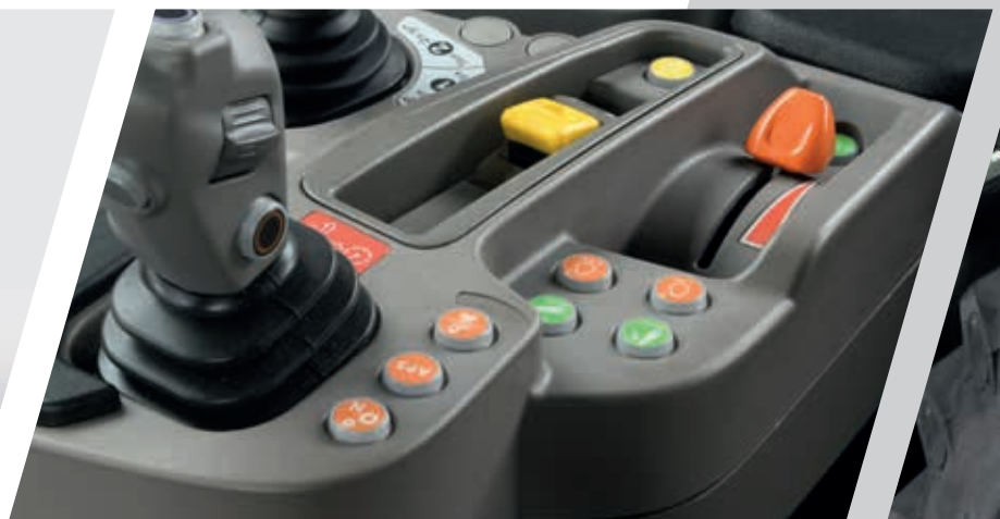
> Accélérateur manuel électronique avec 2 régimes de mémorisation moteur.
