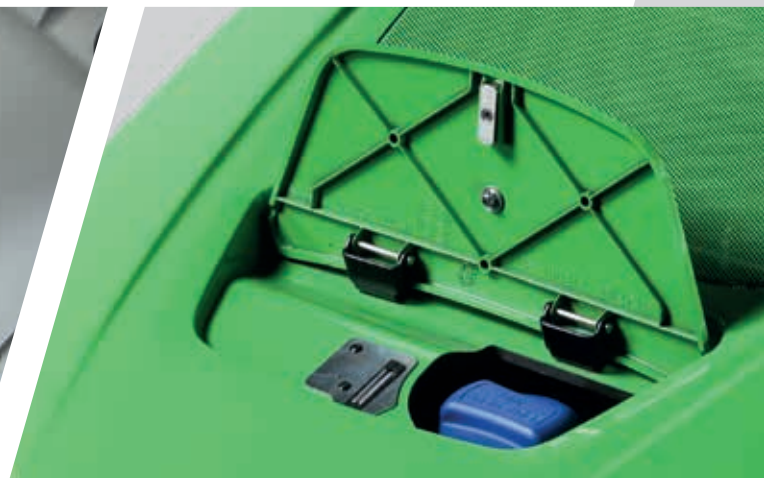
> Vlot toegankelijke AdBlue-tank.
