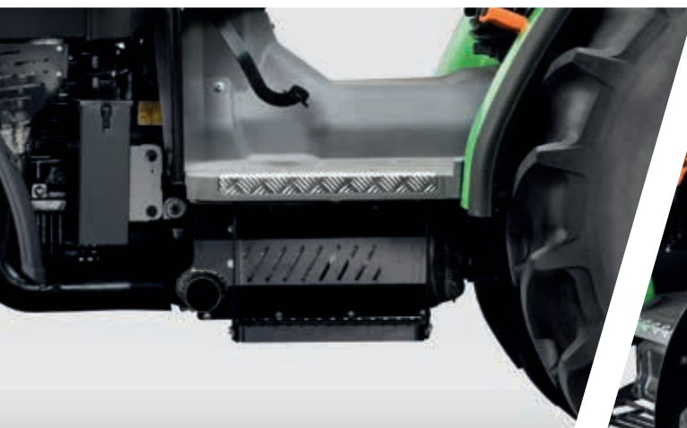
> Volledig geïntegreerd EAT-systeem. SCR en DPF die de hoogte van de spatborden en de afmetingen van de motorkap niet beïnvloeden.
