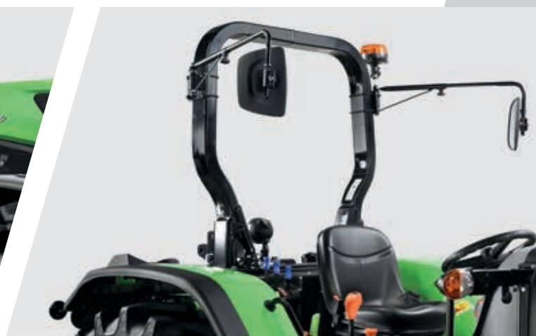
> Lusterka wsteczne zamontowane na konstrukcji ramy.
