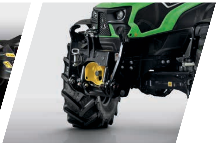
> Podnośnik przedni ze składanymi ramionami.
