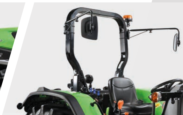
> Espelhos retrovisores instalados na ROPS.
