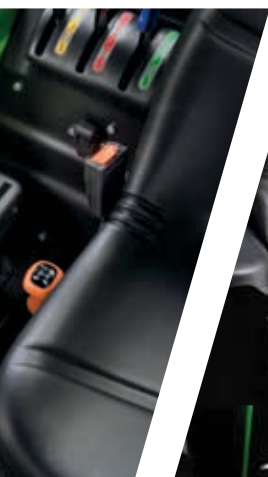
> 3 Steuerventile im Heck mit Schnellkupplungen.
