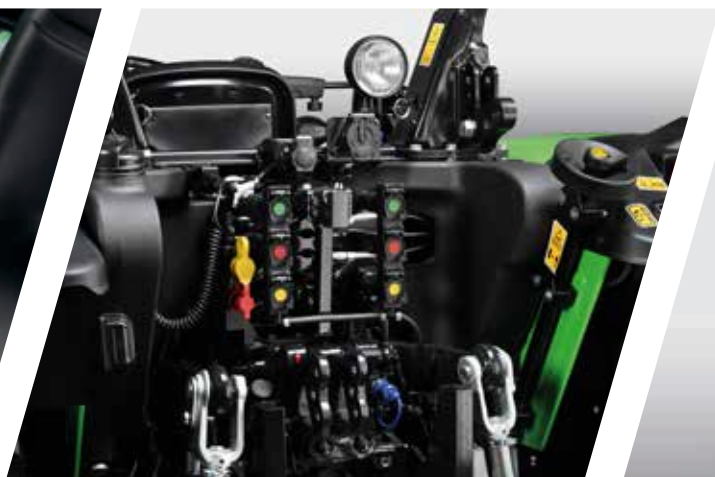
> 3 Steuerventile im Heck mit Schnellkupplungen.
