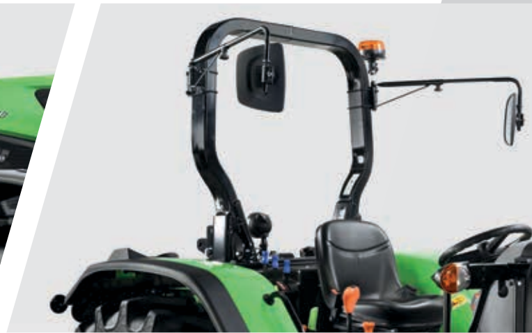
> Auf dem ROPS montierte Rückspiegel.
