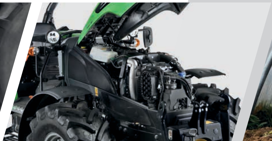
> Einfache Wartung dank der weit öffnenden Motorhaube.
