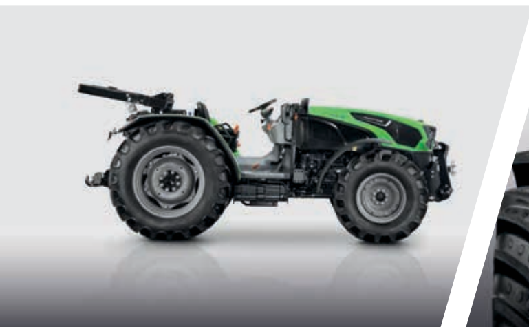
> Klappbarer ROPS mit 2 Pfosten.
