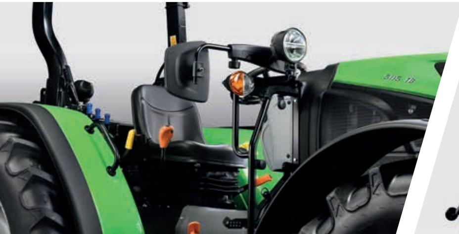
> An der Vorderseite der Plattform montierte Rückspiegel.
