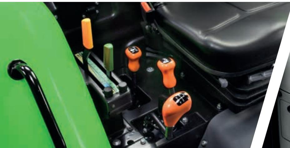
> Zuverlässiges Getriebe mit mechanischer Wendeschaltung.
