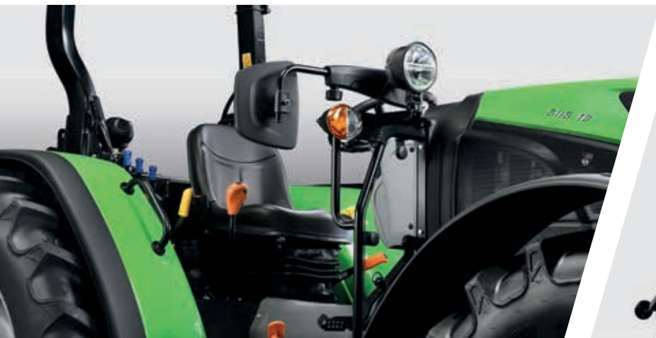
> Los retrovisores pueden instalarse en la parte delantera de la plataforma.
