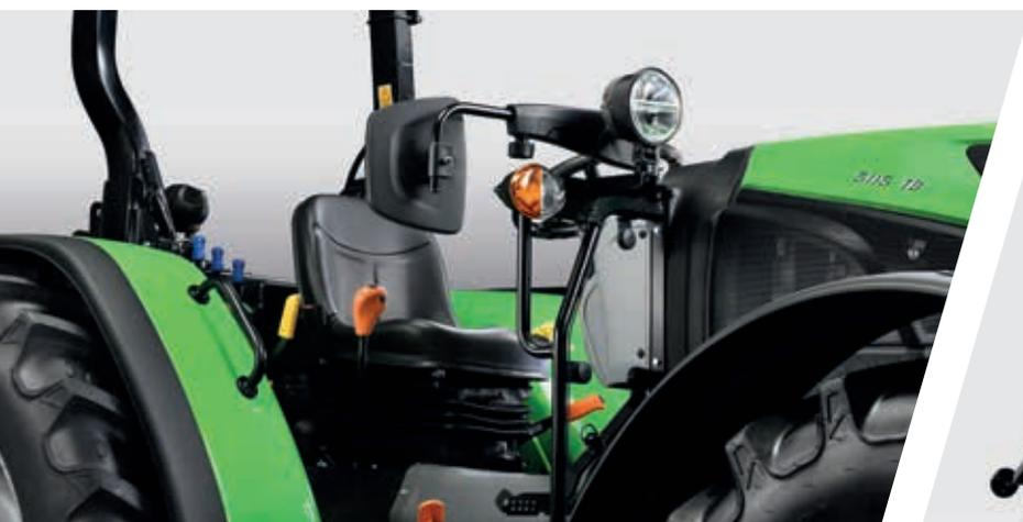
> Rétroviseurs installés à l'avant de la plateforme.
