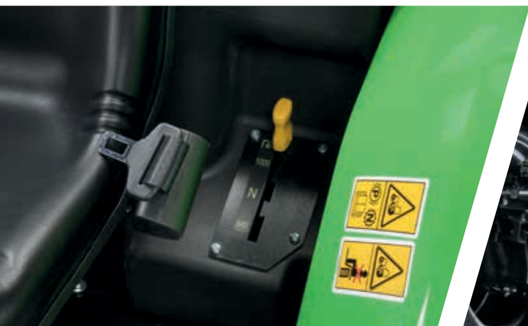
> PTO posteriore fino a 4 velocità di serie.
