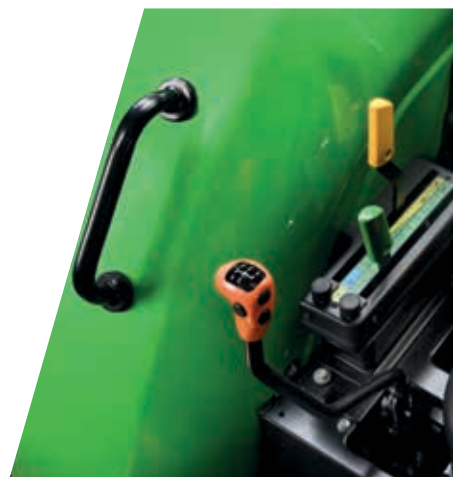
> Sollevatore posteriore a comando meccanico preciso e accurato.
