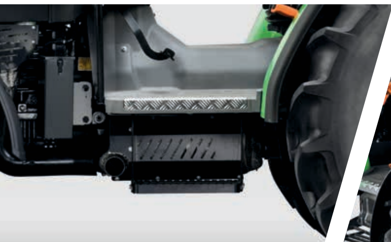
> Sistema EAT totalmente integrato. L'installazione di SCR e DPF non ha alcun impatto sull'altezza dei parafanghi e sulle dimensioni del cofano.
