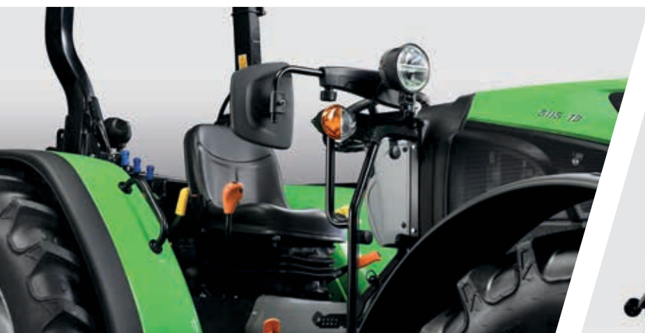
> Specchietti retrovisori installati davanti alla piattaforma.
