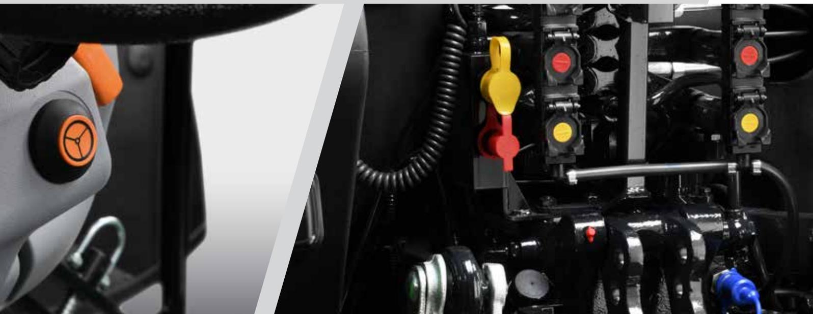
> Freno rimorchio idraulico sia in ITA che Dual Mode in conformità alla Mother Regulation.
