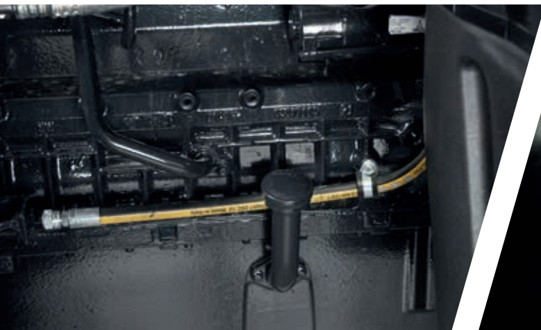
> Se puede acceder a la varilla del aceite del motor sin tener que abrir el capó.
