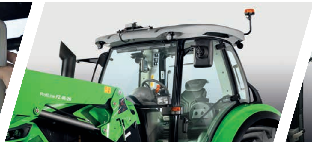
> El preciso receptor SR20 montado en el techo de la cabina.
