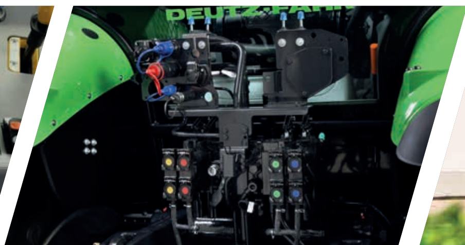
> Zona de enganche trasero con cuatro válvulas mecánicas y acoplamientos Power Beyond.
