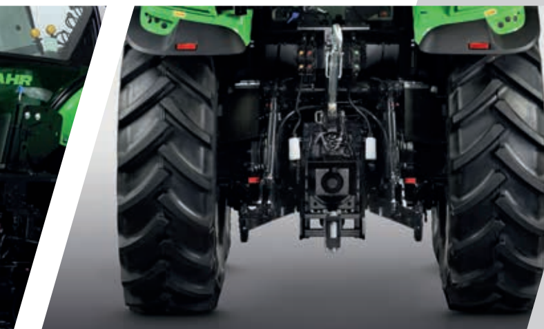
> Elevador trasero con una capacidad de carga de 9700 kg.
