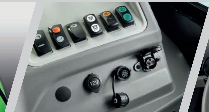
> Botones de control del cargador frontal y tomas de corriente.
