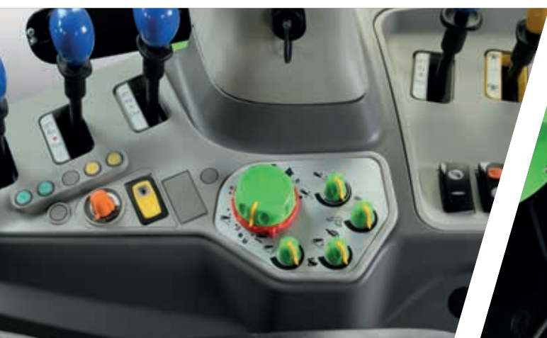
> Cuatro mandos monopalanca ergonómicos y de fácil acceso para accionar las válvulas hidráulicas de accionamiento mecánico.
