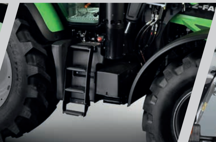
> Interruptor principal de la batería y compartimento de la batería en el lado derecho del tractor.
