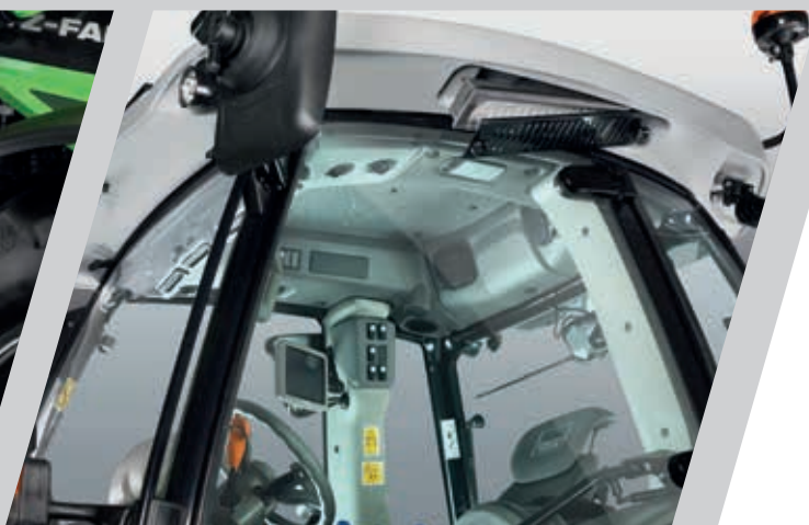
> A los filtros de aire de la cabina se accede fácilmente por la parte inferior del techo.
