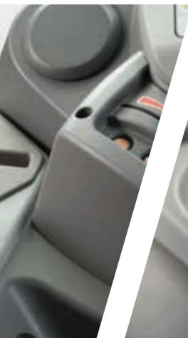
> Palanca ergonómica del inversor PowerShuttle con selector de ajuste SenseClutch.
