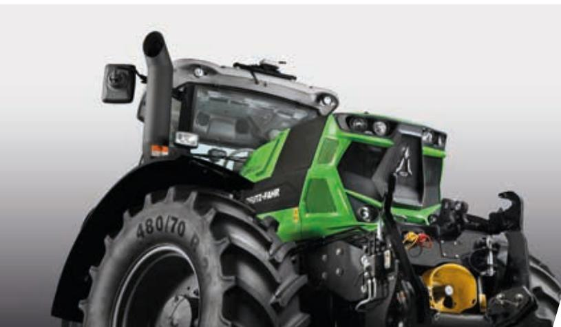
> Elevador delantero con una capacidad de elevación de hasta 3850 kg y TDF delantera opcional de 1000.
