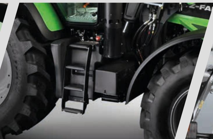
> Interruptor principal de la batería y compartimento de la batería en el lado derecho del tractor.
