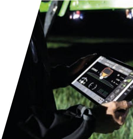
> Con XTEND se pueden controlar los implementos con ISOBUS UT estando fuera de la cabina.
