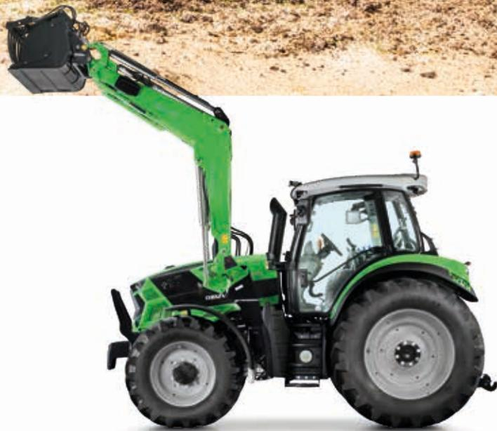
> Los nuevos cargadores frontales ProfiLine llevan todos los conductos hidráulicos integrados en la guía de la viga de carga para que estén bien protegidos y el conductor disponga de una vista despejada.
