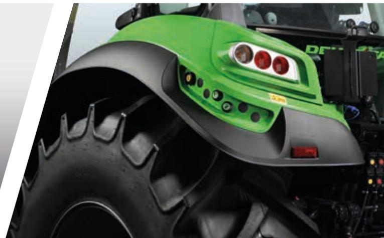
> Elementos de control externos en los guardabarros traseros para la elevación y la TDF.
