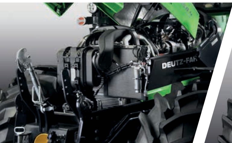
> Filtr powietrza PowerCore i aluminiowy układ chłodzenia z kratką ułatwiającą czyszczenie w 6130.4 - 6150.4.
