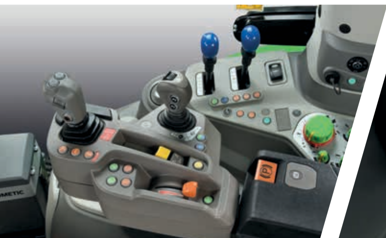
> Zaawansowany podłokietnik z 3 programowalnymi przyciskami i programowalnym pokrętle.
