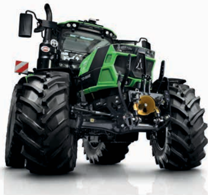
> Przednia amortyzowana oś ze 100% blokadą przedniego mechanizmu różnicowego.
