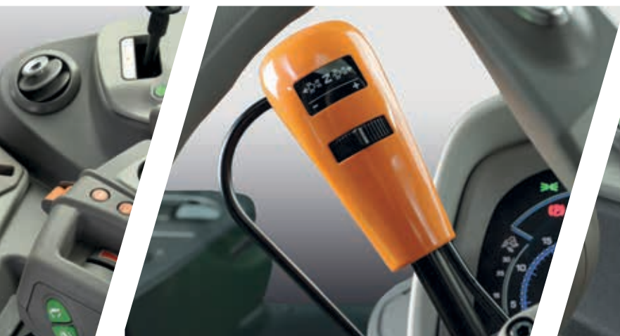
> Ergonomiczna dźwignia rewersu PowerShuttle z pokrętłem regulacji agresywności SenseClutch.
