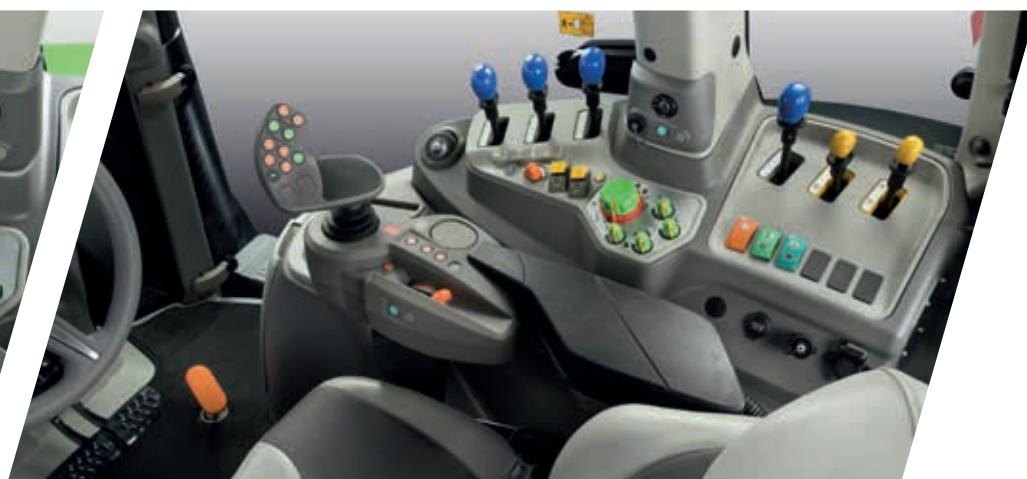
> MaxiVision z mechanicznie sterowaną hydrauliką (niebieskie dźwignie) w napędzie Powershift (duże zdjęcie) i RCshift (zdjęcie powyżej).
