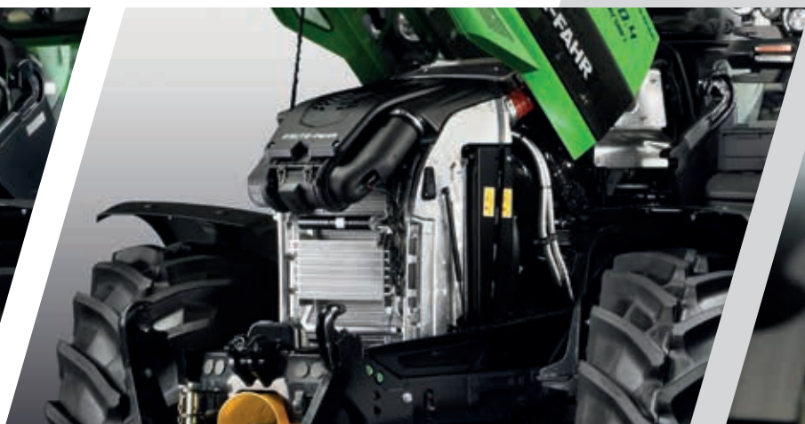
> Filtr PowerCore i aluminiowe chłodnice z dźwignią blokady – łatwe otwieranie w celu czyszczenia w modelach 6160.4 - 6170.4.
