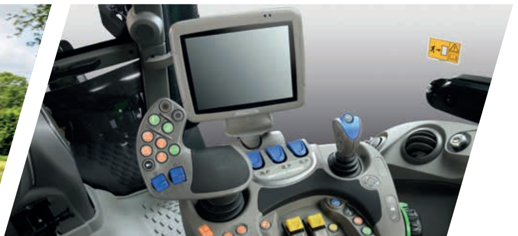
> Joystick MaxCom z przyciskami podnośnika, napędu, ComforTip, hydrauliki i dwoma przyciskami programowalnymi.
