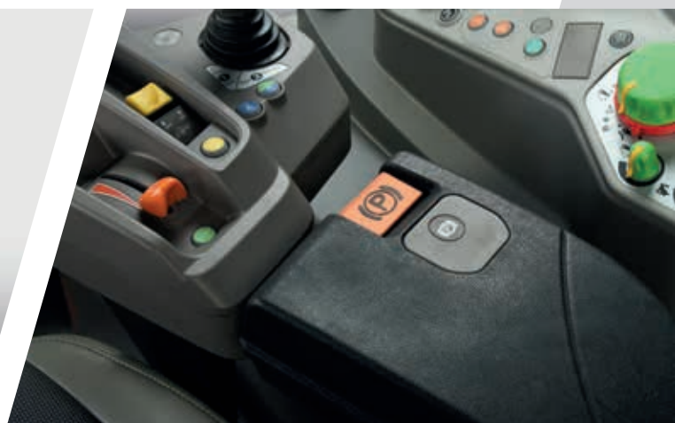
> Elektroniczny hamulec postojowy (EPB) w modelach RVshift i TTV.
