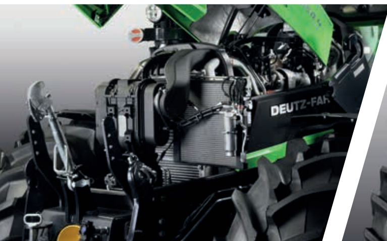
> Filtr powietrza PowerCore i aluminiowy układ chłodzenia z kratką ułatwiającą czyszczenie w 6130.4 - 6150.4.
