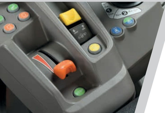
> Acelerador manual eletrônico com duas memórias de velocidade.
