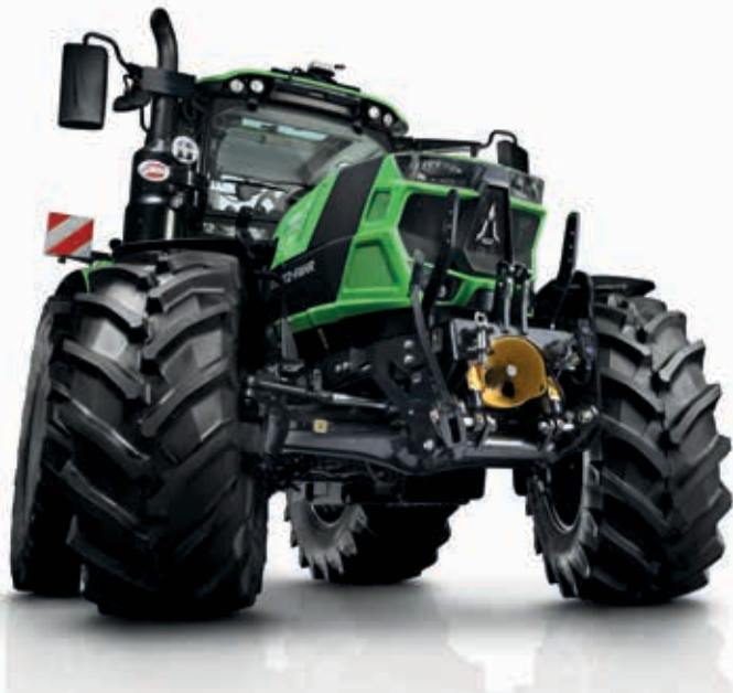
> Eixo dianteiro suspenso com bloqueio do diferencial dianteiro a 100%.
