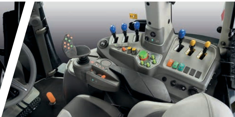
> Até quatro comandos mecânicos com controlo ergonómico por uma só alavanca.
