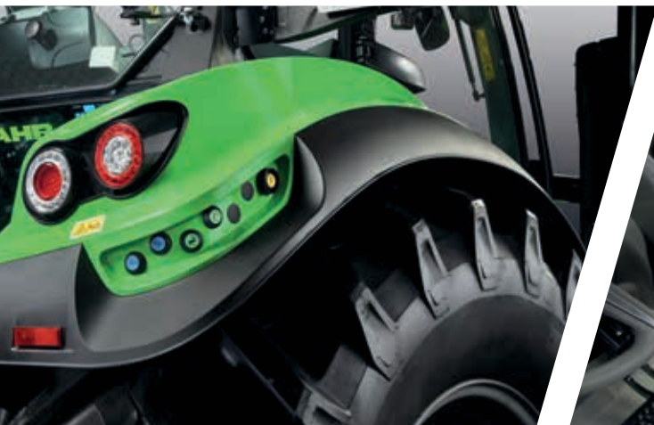
> Comandos exteriores em ambos os lados para o elevador traseiro e a TDF e, consoante o modelo, um distribuidor.
