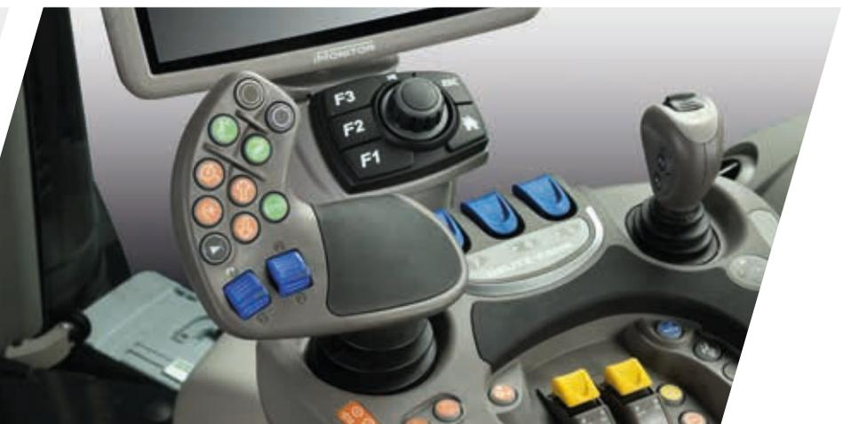
> Para controlar os distribuidores elétricos, o operador pode escolher entre os controles azuis na ponta dos dedos, o pequeno joystick ou as práticas rodas seletoras no joystick MaxCom.
