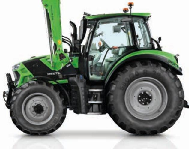
> Os novos carregadores frontais ProfilLine integram todas as linhas hidráulicas dentro dos montantes, para garantir que estão bem protegidas e o condutor tem uma visão desobstruída.
