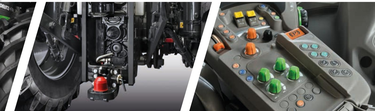
> Com carga vertical de 3000 kg, o engate esférico K80 também permite engatar reboques pesados.
