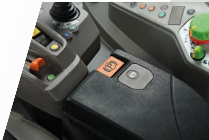
> Travão de Estacionamento Eletrónico (EPB) nos modelos RVshift e TTV.
