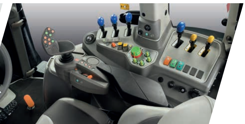
> Equipamento da cabina MaxiVision com distribuidores traseiros totalmente mecânicos em combinação com transmissão Powershift (imagem grande) e RCshift (imagem acima).
