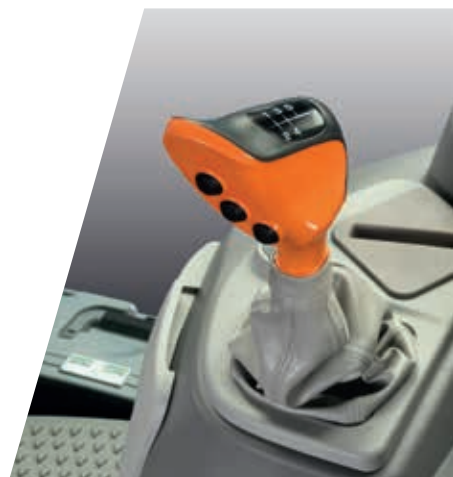
> Alavanca de velocidades ergonômica com botões ComfortClutch, APS e Powershift.
