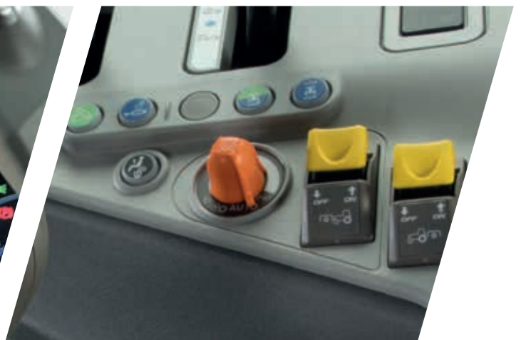
> Fácil e intuitivo – com o botão de ajuste ECO/Power, o operador pode alterar o comportamento de mudança APS (Automatic Powershift).
