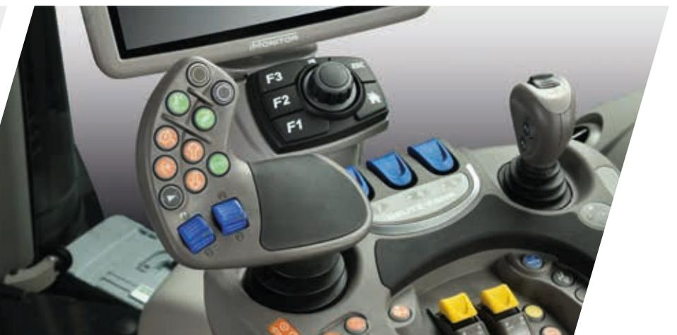
> Zur Steuerung der elektrischen Steuerventile kann der Bediener zwischen den blauen Fingertip-Bedienelementen, dem kleinen Joystick oder den praktischen Daumenrädern am MaxCom-Joystick wählen.
