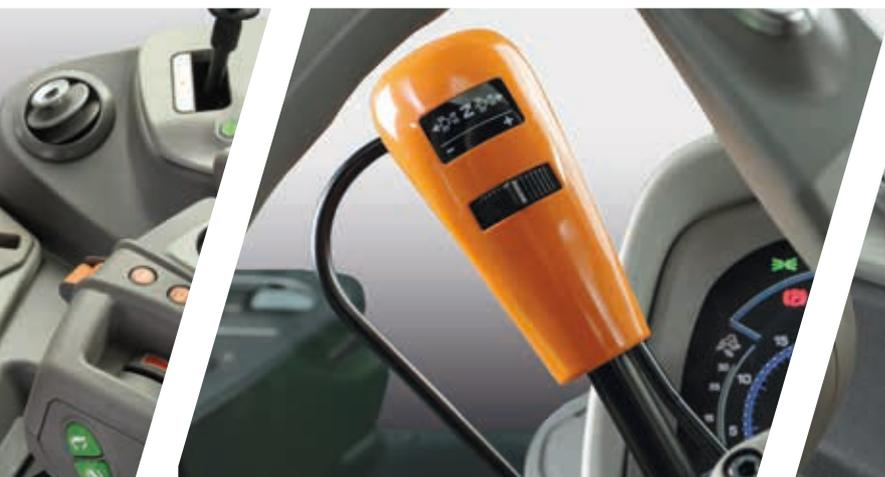
> Ergonomischer PowerShuttle-Hebel mit SenseClutch-Einstellrad.
