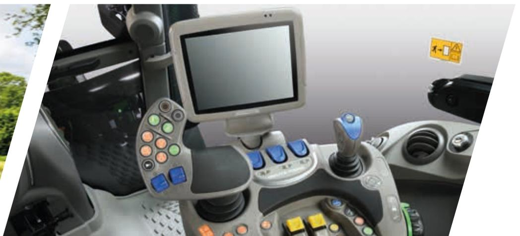
> Ergonomischer MaxCom-Joystick mit Bedienelementen für Kraftheber, Tempomaten, Richtungswechsel, Vorgewendemanagement, zwei proportionale Hydraulikventile und zwei frei belegbaren Jolly-Tasten.
