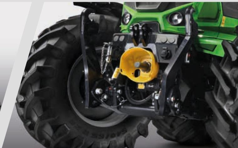
> Robuster Frontkraftheber mit 3000 kg Hubkraft und integrierte Frontzapfwelle bei den Modellen 6130.4 - 6150.4.
