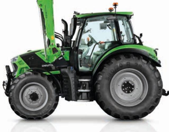
> Bei den neuen ProfilLine-Frontladern sind alle Hydraulikleitungen geschützt in den Laderrahmen integriert, so dass der Fahrer freie Sicht hat.
