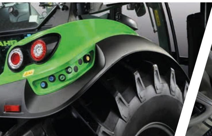
> Externe Bedienelemente auf beiden Seiten für Heckkraftheber und Zapfwelle sowie je nach Modell ein Steuergerät.
