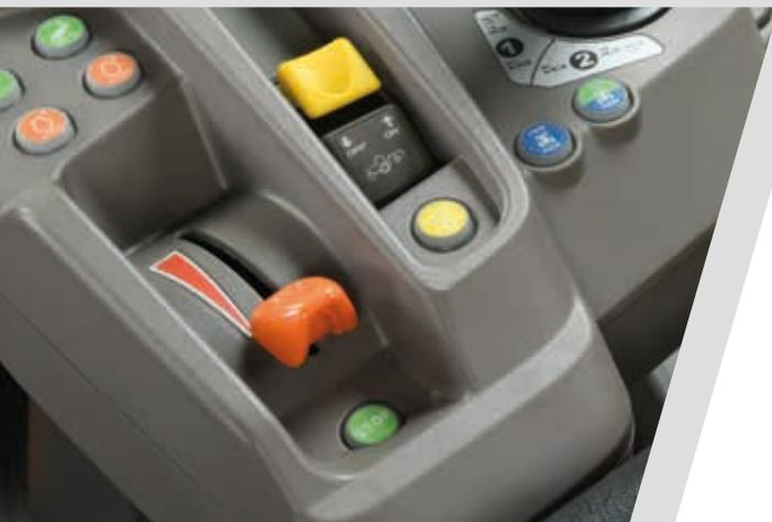
> Elektronische Handgasvorrichtung mit zwei speicherbaren Drehzahlen.
