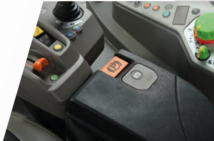
> Elektronische Feststellbremse (EPB) bei RVshift- und TTV-Modellen.
