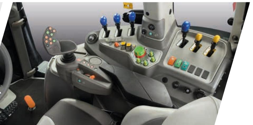
> MaxiVision Kabinenausstattung mit vollmechanischen hinteren Zusatzsteuerventilen in Kombination mit Powershift (großes Bild) und RCshift (Bild oben) Getriebe.
