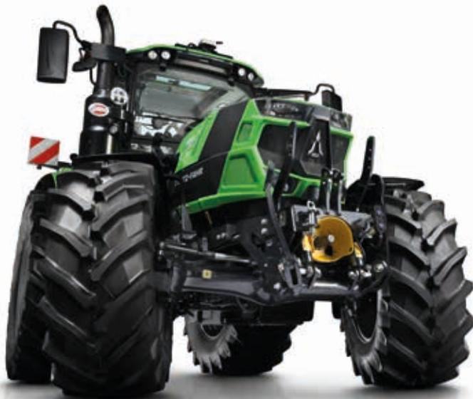
> Gefederte Vorderachse mit 100%-Differentialsperre vorne.
