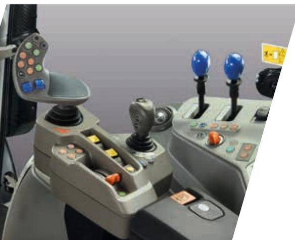
> Bei Modellen mit RCshift-Getriebe werden die hinteren Steuerventile mit den Daumenrädern am MaxCom-Joystick und zwei mechanischen Bedienhebeln gesteuert, während der Kreuzhebel zur Steuerung des Frontladers verwendet werden kann.
