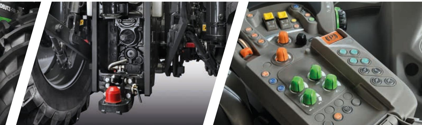
> Mit 3000 kg Stützlast erlaubt die K80-Kugelkopf-Anhängervorrichtung auch den Anschluss von schweren Anhängern.
