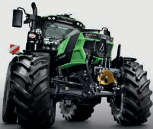
> Gefederte Vorderachse mit 100%-Differentialsperre vorne.
