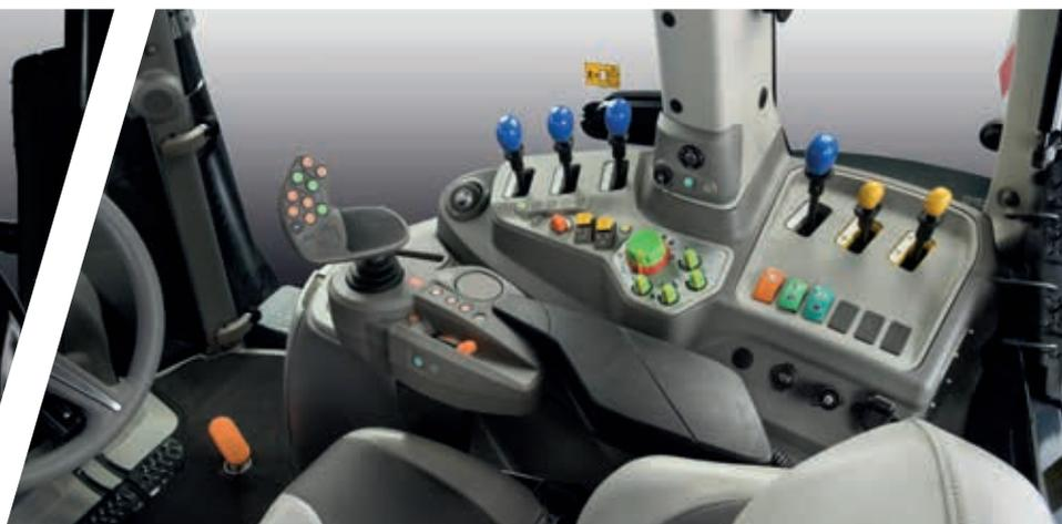
> Bis zu vier mechanische Bedienelemente mit ergonomischer Einhebelsteuerung.
