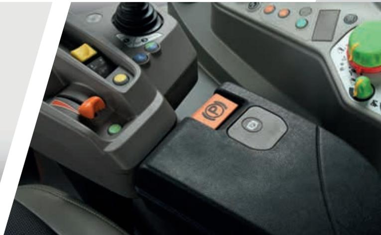
> Elektronische Feststellbremse (EPB) bei RVshift- und TTV-Modellen.
