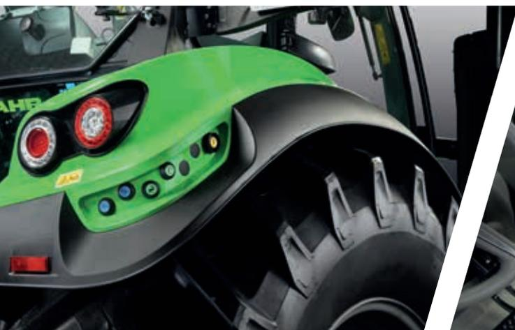
> Externe Bedienelemente auf beiden Seiten Heckkraftheber und Zapfwelle sowie je nach Modell ein Steuergerät.
