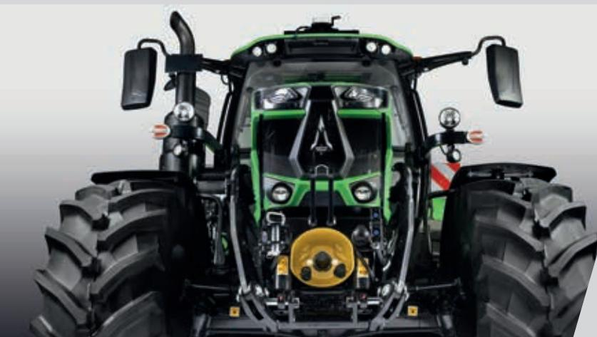
> Effizienter Frontkraftheber mit 3800 Kg Hubkraft und integrierte Frontzapfwelle für Modelle 6160.4 - 6170.4 erhältlich.
