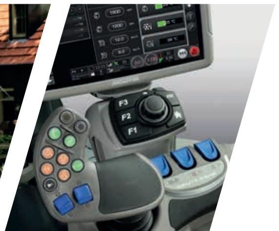
> Bei Modellen mit MaxiVisionPro kann der iMonitor auch bequem über das MMI-Bedienelement bedient werden.
