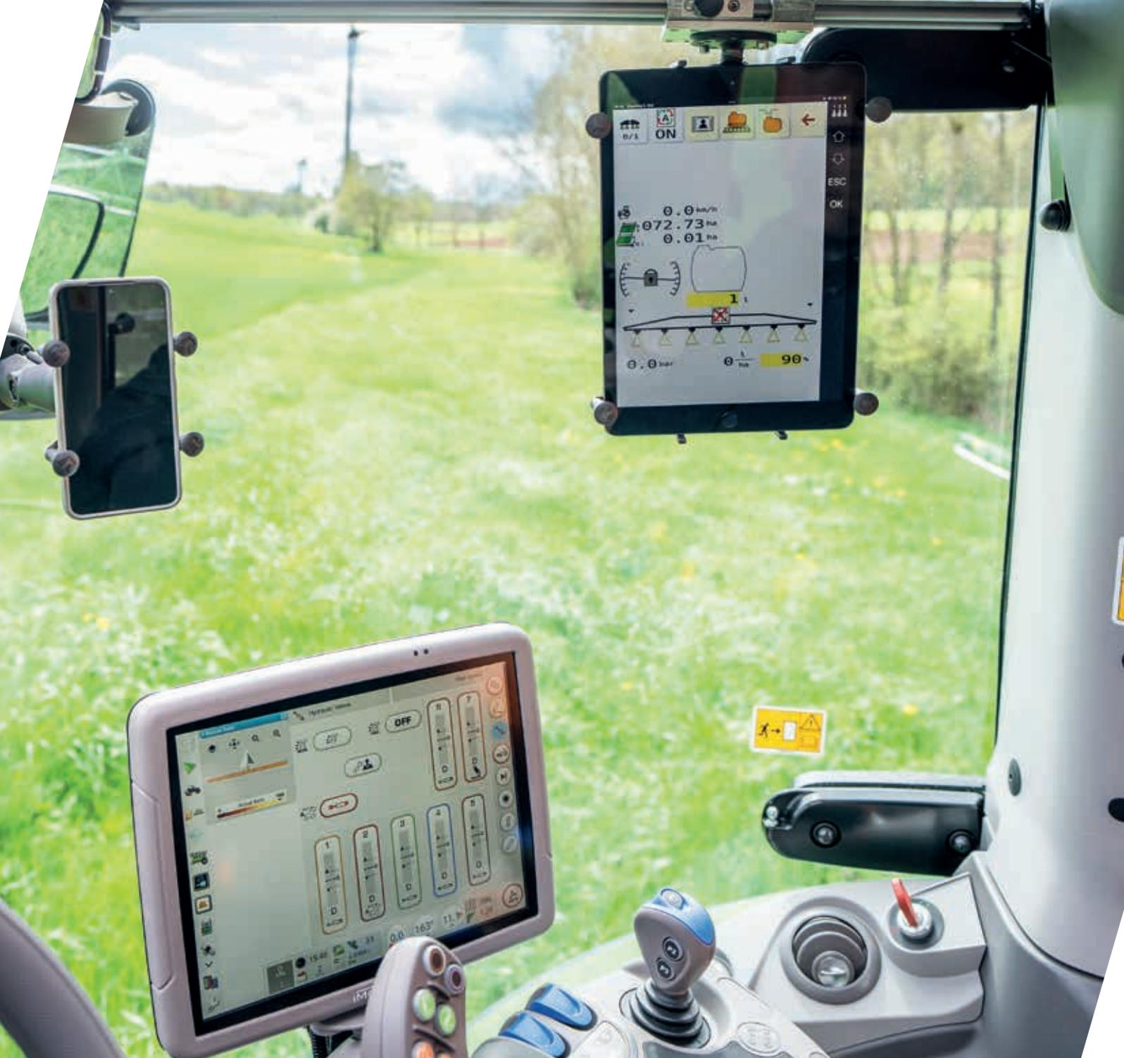
> Die XTEND-Funktion ermöglicht die Anzeige von SDF Guidance oder die Steuerung eines ISOBUS-Geräts auf einem externen Gerät, z. B. einem Tablet.
