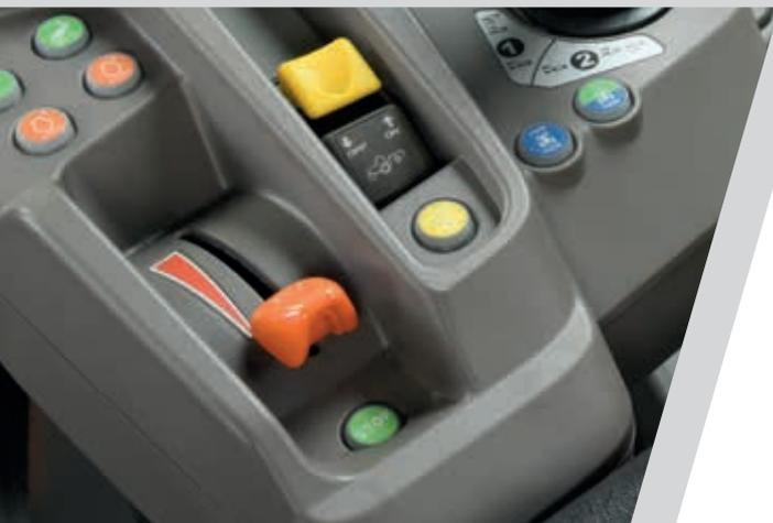
> Elektronische Handgasvorrichtung mit zwei speicherbaren Drehzahlen.
