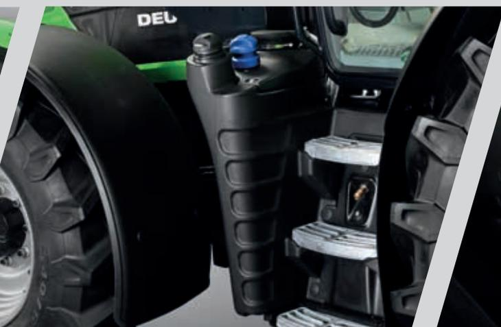
> Der große Kraftstofftank, der Druckluftversorgungsanschluss und die Aufstiegsbeleuchtung liegen für beste Zugänglichkeit zwischen den Stufen.
