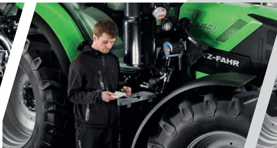
> Auf den Motorölmessstab kann ohne Öffnen der Motorhaube zugegriffen werden.
