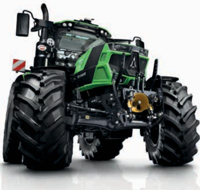
> Eje delantero suspendido con bloqueo del diferencial delantero al 100%.
