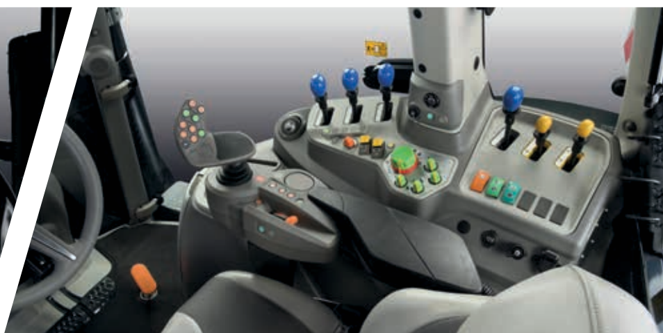
> Jusqu'à quatre commandes mécaniques à levier ergonomique individuel.
