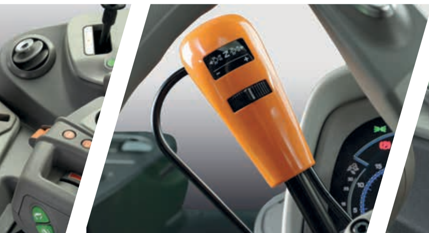
> Levier PowerShuttle ergonomique avec molette de réglage SenseClutch.
