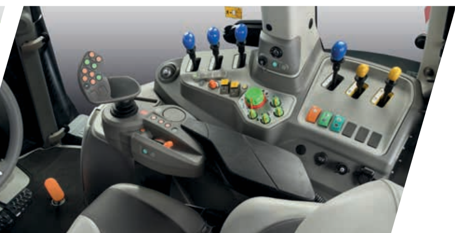
> L'équipement de la cabine MaxiVision à distributeurs arrière entièrement mécaniques est disponible pour les modèles Powershift (grande photo) et RCshift (photo ci-dessus).
