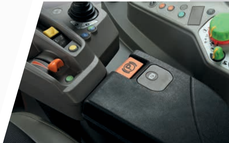
> Electronic Park Brake (EPB) sur les modèles RVshift et TTV.
