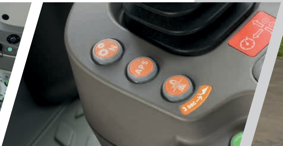
> Sélection des mode de conduite Transport, Champs et Rampantes.
