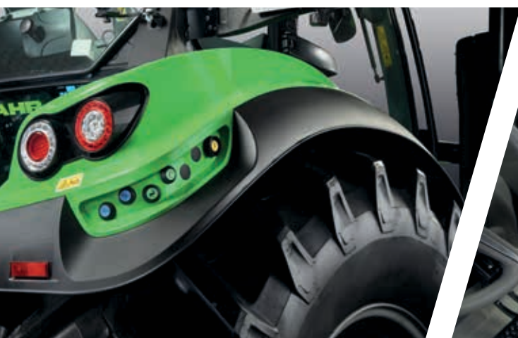
> Commandes extérieures des deux côtés pour le relevage arrière et la PDF et, selon le modèle, un distributeur.
