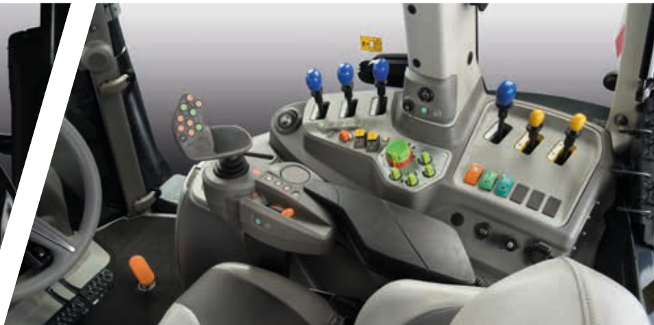
> Ergonomik tek kumanda kontrolü ile dört adede kadar mekanik kontrol.
