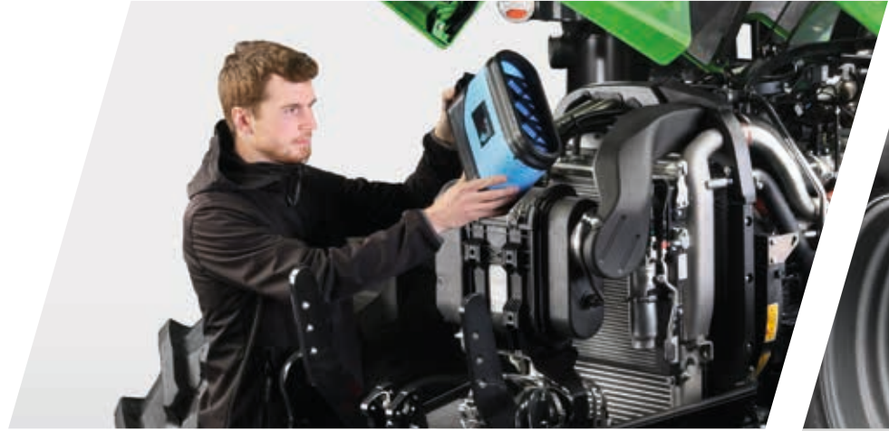
> Tüm modellerde uzun kullanım ömrü sağlayan PowerCore hava filtresi bulunur.
