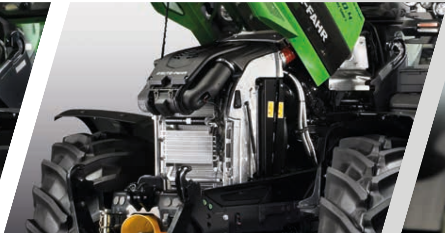
> Tek elle açma koluna sahip PowerCore hava filtresi ve alüminyum soğutma sistemi, 6160.4 - 6170.4 modellerinde temizlik için kolay açılma sağlar.
