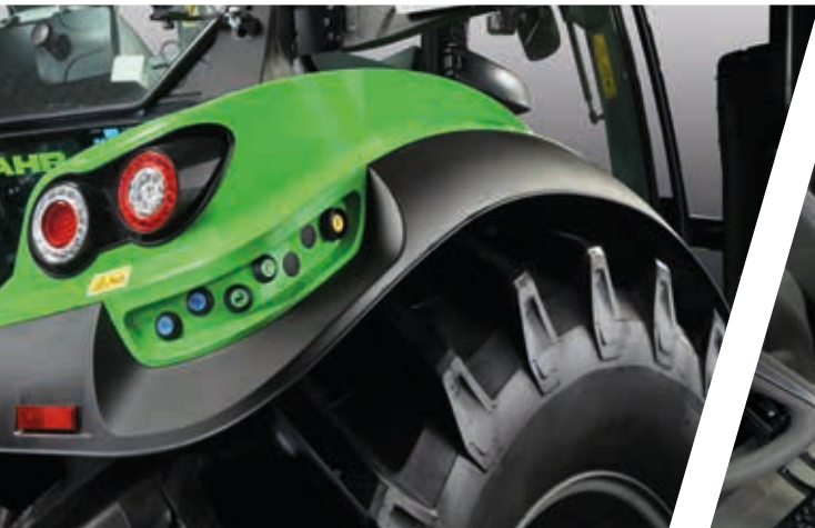
> Arka kaldırıcı ve PTO için her iki tarafta harici kontroller ve modele bağlı olarak bir makara valfi.
