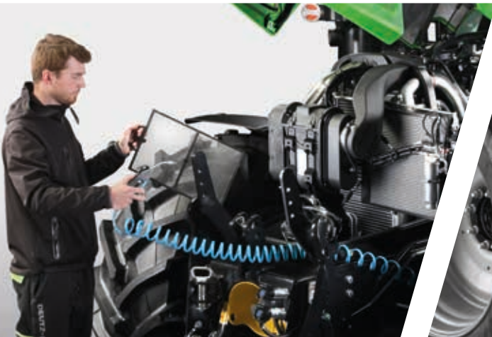
> Radyatör paketinin kolay temizliği.
