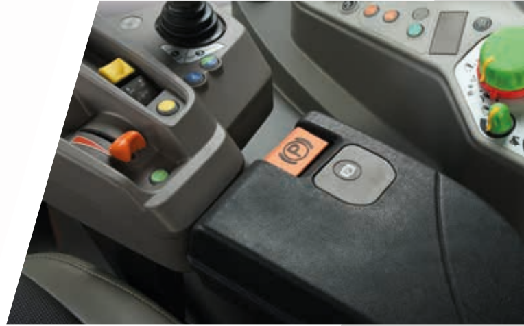
> RVshift ve TTV modellerinde Elektronik Park Freni (EPB).
