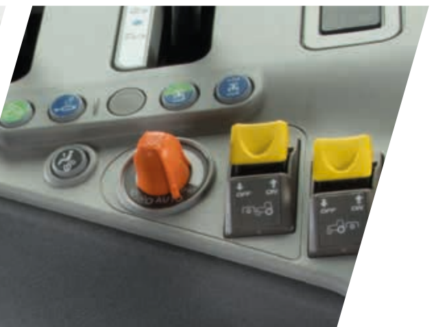
> Kolay ve sezgisel - ECO/Power ayar düğmesi ile operatör APS (Automatic Powershift) vites değiştirme davranışını değiştirebilir.
