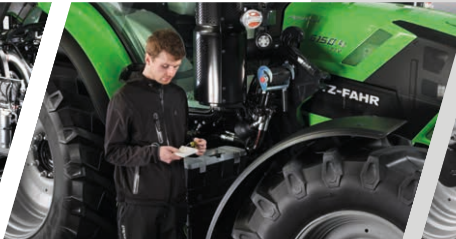
> Motor yağı çubuğu, kaputu açmadan erişilebilir.
