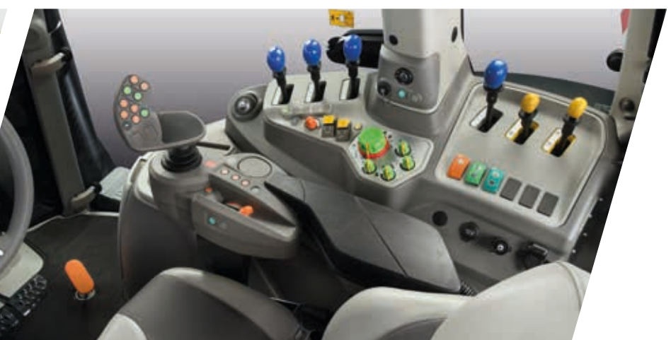
> Powershift (büyük resim) ve RCshift (yukarıdaki resim) şanzıman ile birlikte tam mekanik arka makara valflerine sahip MaxiVision kabin konfigürasyonu.
