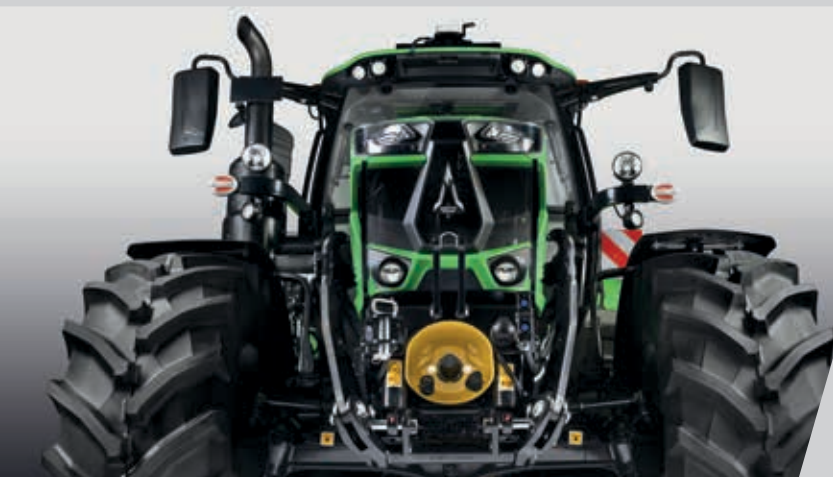
> L'efficiente sollevatore anteriore con capacità di sollevamento di 3800 kg e PTO anteriore integrata disponibile sui modelli 6160.4 - 6170.4.
