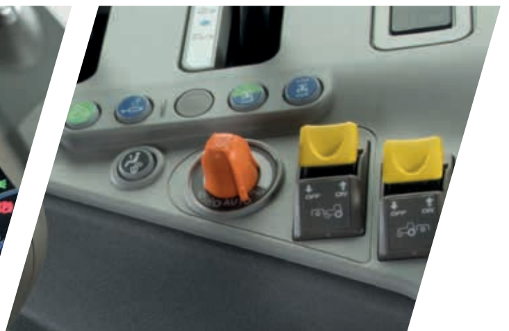
> Uso facile e intuitivo – con la manopola di regolazione ECO/Power l'operatore può modificare la modalità di innesto dell'APS (Automatic Powershift).
