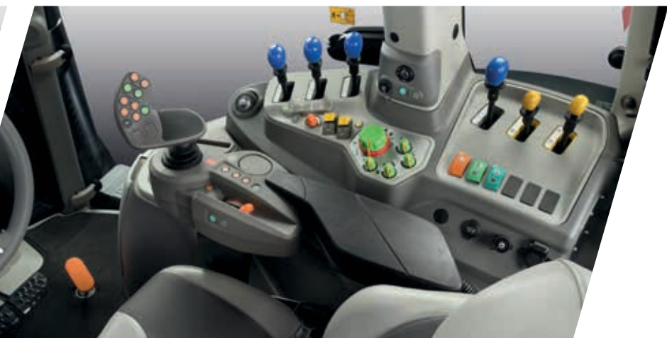
> L'allestimento cabina MaxiVision con distributori posteriori completamente meccanici in abbinamento a trasmissione Powershift (foto grande) e RCshift (foto sopra).
