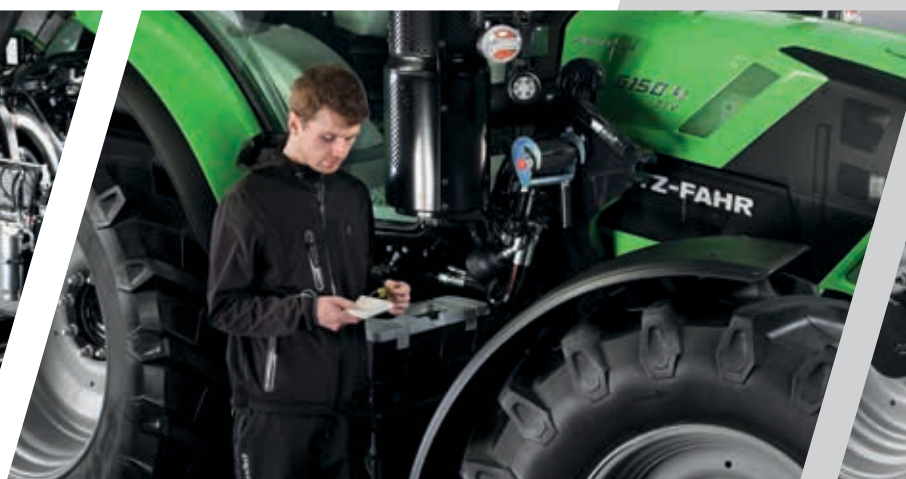
> L'astina per il controllo dell'olio motore è accessibile senza aprire il cofano.
