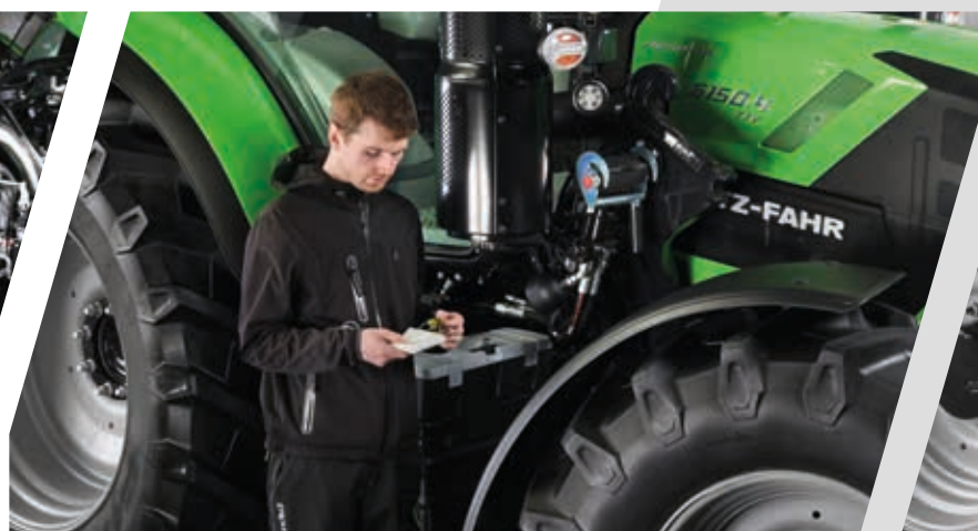
> L'astina per il controllo dell'olio motore è accessibile senza aprire il cofano.
