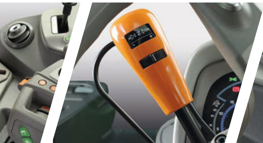
> Ergonomica leva dell'inversore PowerShuttle con manopola di regolazione SenseClutch.
