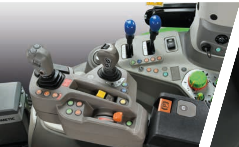
> Bracciolo avanzato con 3 pulsanti jolly liberamente programmabili e un potenziometro jolly liberamente programmabile.
