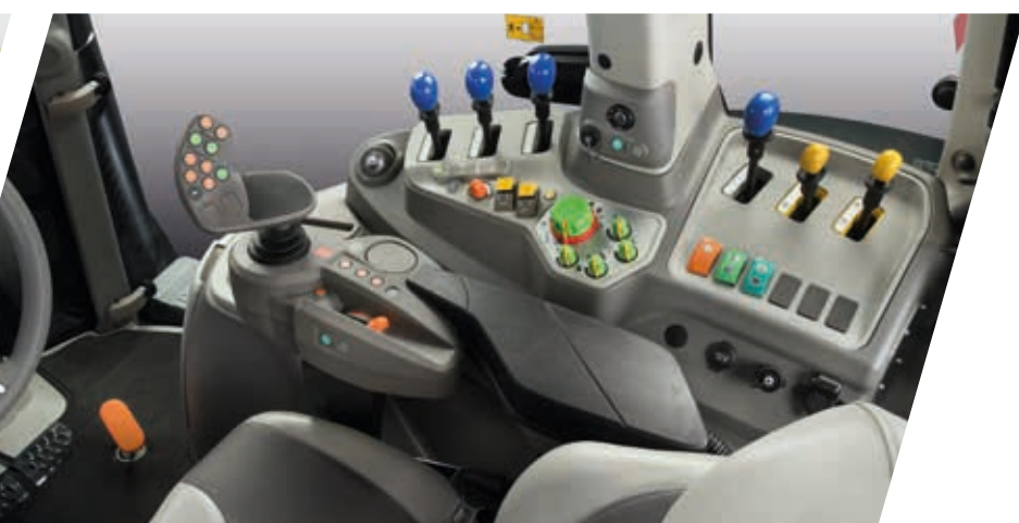
> L'allestimento cabina MaxiVision con distributori posteriori completamente meccanici in abbinamento a trasmissione Powershift (foto grande) e RCshift (foto sopra).
