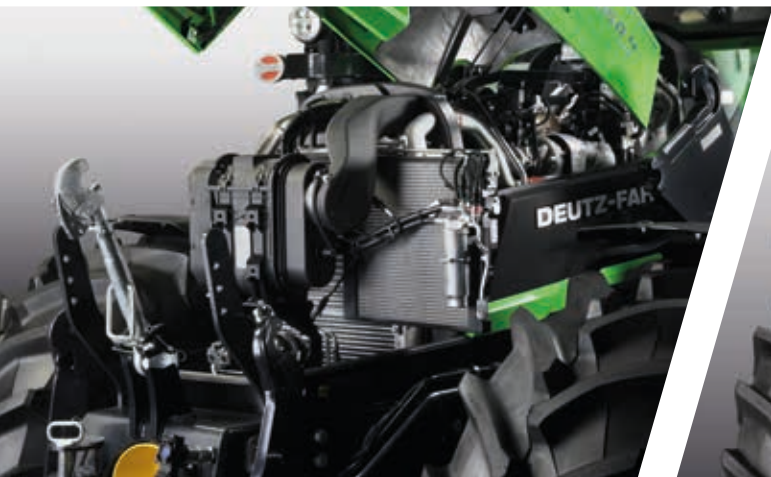
> Filtro dell'aria comburente PowerCore e sistema di raffreddamento in alluminio con griglia radiatore estendibile lateralmente per un'agevole pulizia sui modelli 6130.4 - 6150.4.
