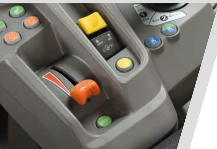
> Acceleratore manuale elettronico con due regimi motore memorizzabili.
