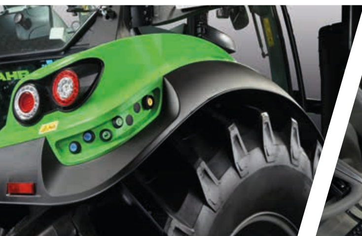
> Comandi esterni su entrambi i lati per sollevatore posteriore e PTO e, a seconda del modello, un distributore.
