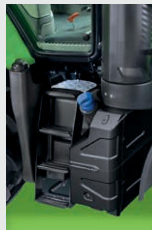
De 6-cilindermodellen hebben aan beide zijden tankvulhalzen voor meer gebruiksgemak.
