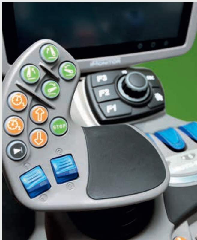
↑ Met twee knoppen op de MaxCom multifunctionele joystick kan de bestuurder vier verschillende snelheidsinstellingen gebruiken voor veldwerk of gebruik op de weg om een constante snelheid aan te houden voor optimale resultaten.
