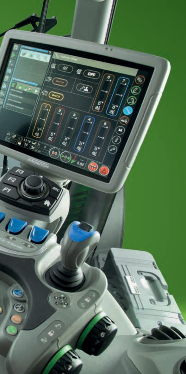
↑ De hydraulische ventielen zijn voorzien van proportionele bediening en volledig programmeerbaar op tijd en hoeveelheid. De elektronische joystick kan worden geprogrammeerd om de voorlader te bedienen, terwijl andere regelventielen met het duimwiel bediend kunnen worden.
