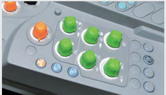
↑ De bediening van de frontheef en achterheef kan nauwkeurig worden afgesteld met de potentiometers in de armleuning.
