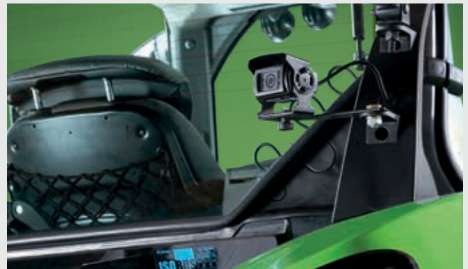
↑ Geïntegreerde camera met automatische fullscreen-modus (bijv. achteruitrijden) voor overzicht en veiligheid.
