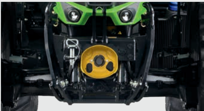
↑ Positiegestuurde fronthef met maximaal 5450 Kg hefvermogen.
