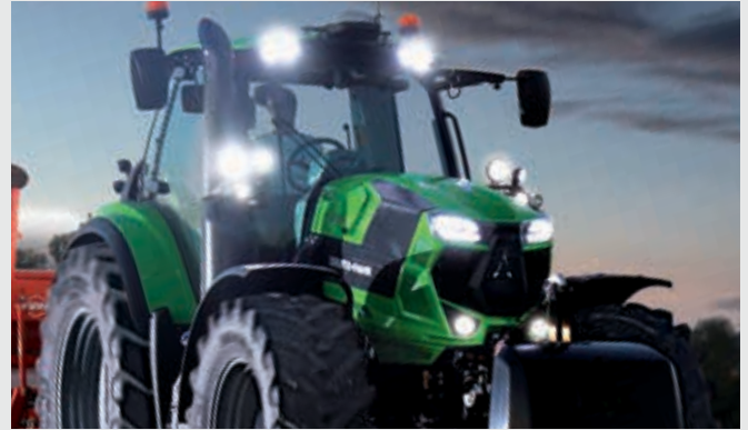
↑ LED-pakket tot 2500 lm per werkklamp (afhankelijk van het model).
