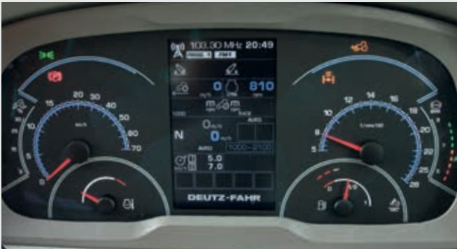
↑ Modern dashboard met InfoCentre Pro : 5" scherm met hoge resolutie. Het beschikbare iLock-systeem zorgt voor veiligheid - vergrendel en ontgrendel de tractor met een pincode.
