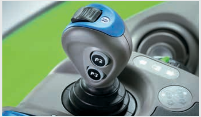
↑ De hydraulische ventielen zijn voorzien van proportionele bediening en volledig programmeerbaar op tijd en hoeveelheid. De elektronische joystick kan worden geprogrammeerd om de voorlader te bedienen, terwijl andere regelventielen met het duimwiel bediend kunnen worden.
