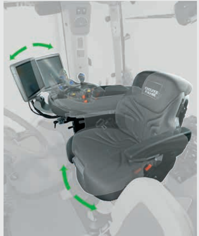
↑ Verkrijgbaar voor alle TTV-modellen: Stoel met een draaihoek tot 23° voor extra comfort en bedieningsgemak.
