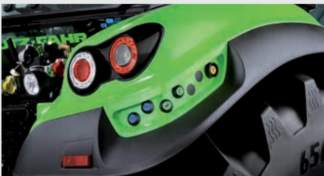
↑ Eenvoudige bediening van het hydraulisch systeem, de achterhef en de aftakas van buitenaf vanaf beide zijden.
