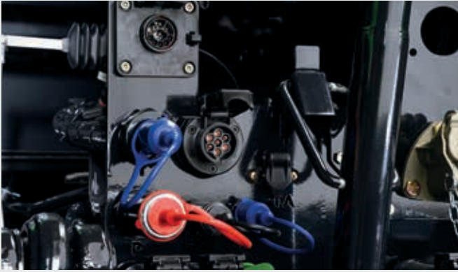
↑ De ISOBUS-interfaces van DEUTZ-FAHR aan de voor- en achterzijde maken de tractor compatibel met aanbouwdelen van alle gerenommeerde fabrikanten.
