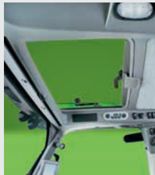
↑ Drie verschillende dakuitvoeringen. Best mogelijke zicht voor voorladerwerk.
