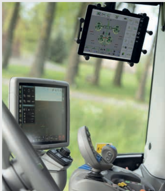
↑ Met de XTEND-functie kunt u SDF Guidance weergeven of kunt u een ISOBUS-werktuig bedienen via een extern apparaat, bijvoorbeeld een tablet.
