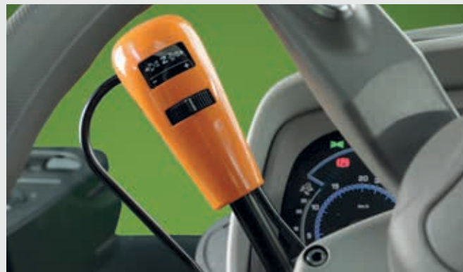
↑ PowerShuttle met SenseClutch en vijf afstelniveaus.
