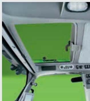
↑ Trzy różne konfiguracje dachu. Najlepszy widok do pracy z ładowaczem czołowym.
