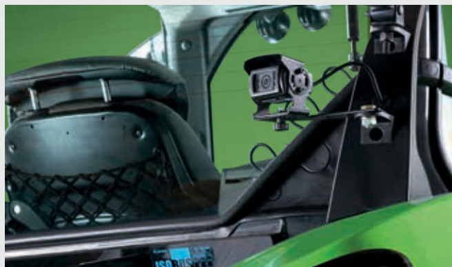
↑ Zintegrowana kamera z automatycznym trybem pełnoekranowym (np. zmiana kierunku jazdy) w celu podglądu i zapewnienia bezpieczeństwa.
