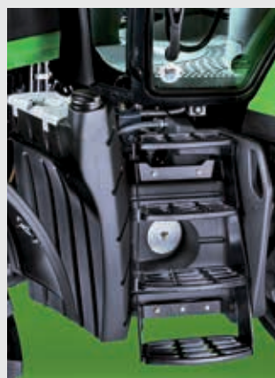
↑ Wygodne schodki wejściowe wbudowane w zbiornik paliwa.
