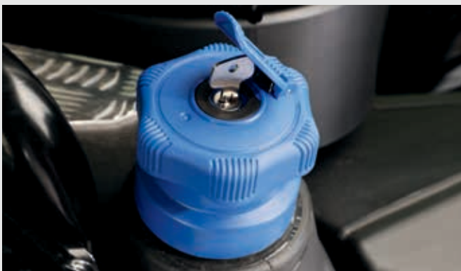
↑ Zamykane korki zbiornika na paliwo oraz zbiorników na AdBlue.
