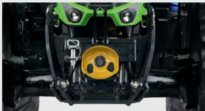
↑ Przedni podnośnik z regulacją położenia o udźwigu do 5450 Kg.
