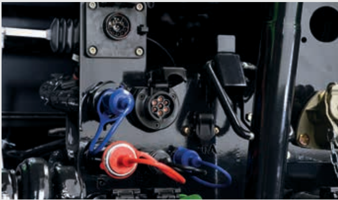
↑ Złącza ISOBUS DEUTZ-FAHR z przodu i z tyłu sprawiają, że ciągnik jest kompatybilny z osprzętem wszystkich renomowanych producentów.
