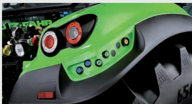
↑ Łatwa obsługa układu hydraulicznego, tylnego podnośnika oraz WOM z zewnątrz, z każdej strony.
