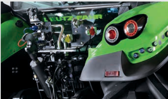
↑ Układ hamulcowy ze sprężonym powietrzem dla przyczep we wszystkich kategoriach wagowych.
