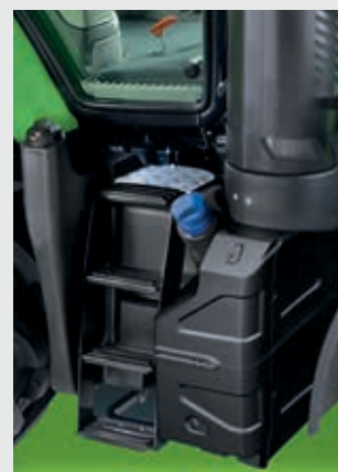
↑ Modele z silnikiem 6-cylindrowym posiadają wlewy paliwa po obu stronach, co zwiększa ich praktyczność.
