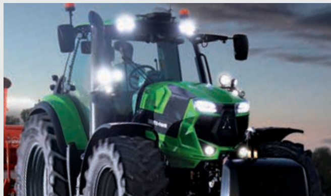
↑ Pakiet oświetlenia ledowego o wydajności do 2500 lm na jedno światło robocze (zależnie od modelu).
