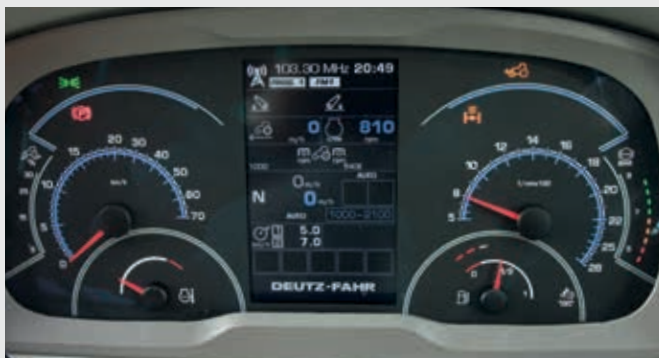
↑ Najnowocześniejsza deska rozdzielcza z InfoCentre Pro : 5" wyświetlacz o wysokiej rozdzielczości. Dostępny system iLock zapewnia bezpieczeństwo - blokowanie i odblokowanie ciągnika za pomocą kodu PIN.
