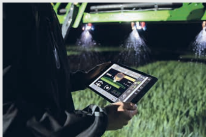
↑ Função XTEND com tablet, controlo de equipamento através do ISOBUS UT quando no exterior da cabina.
