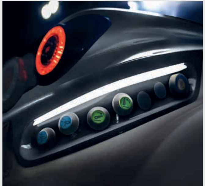
↑ Iluminação LED dos comandos nos guarda-lamas.
