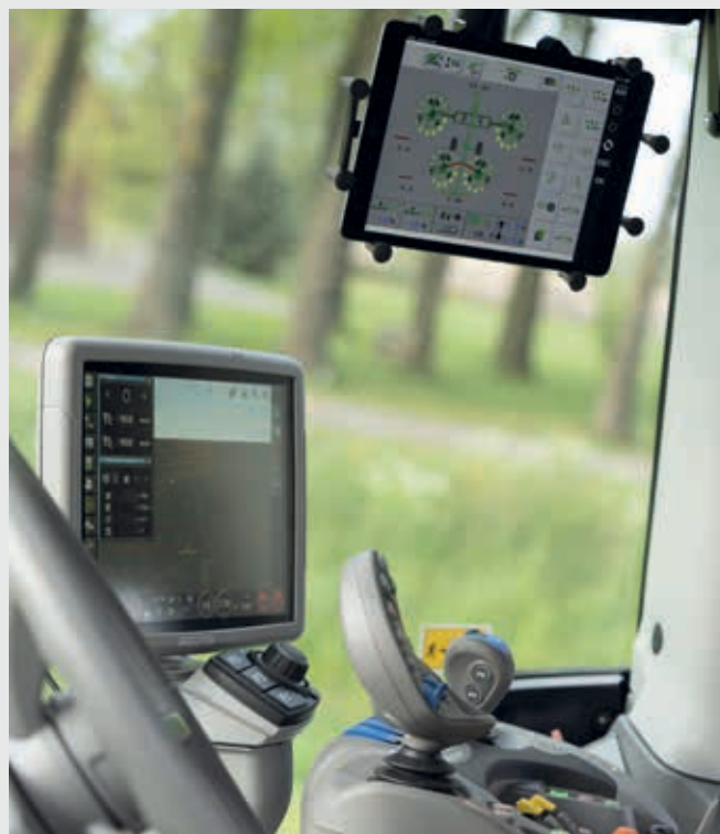
↑ A função XTEND permite a visualização da SDF Guidance ou o controlo de um equipamento ISOBUS num dispositivo externo como, por exemplo, um tablet.
