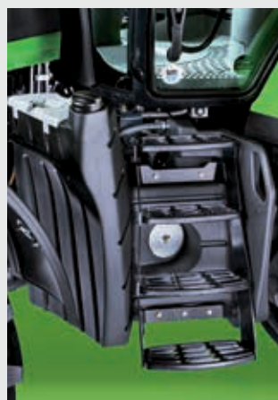
↑ Escadas de acesso confortável, integradas no depósito de combustível.
