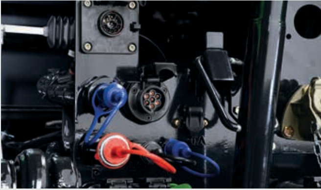
↑ As Interfaces ISOBUS da DEUTZ-FAHR, situadas nas partes dianteira e traseira do trator, asseguram a compatibilidade do trator com os equipamentos de todos os fabricantes conhecidos.
