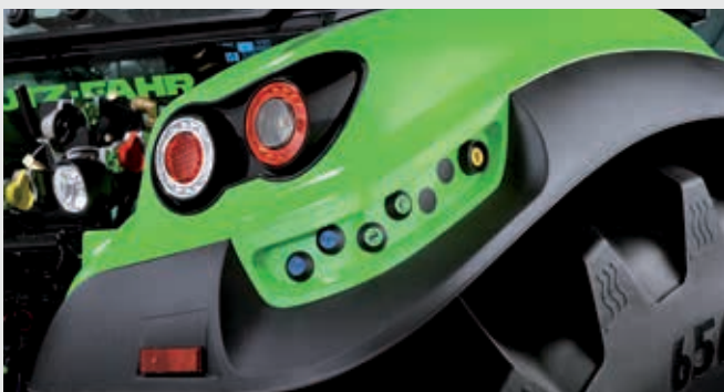
↑ Operação fácil do sistema hidráulico, do elevador traseiro e da TDF, externamente, de qualquer lado.
