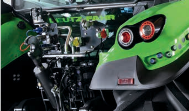
↑ O sistema de travagem a ar comprimido desacelera reboques de todas as categorias, de forma fiável e segura.
