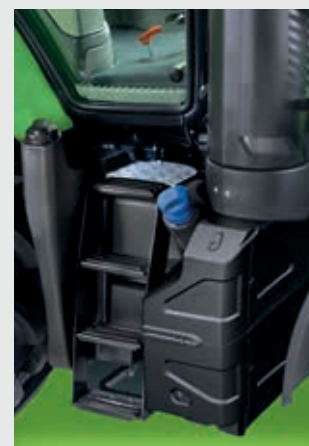
↑ Os modelos de 6 cilindros dispõem de bocais de enchimento do depósito em ambos os lados, para maior conveniência.
