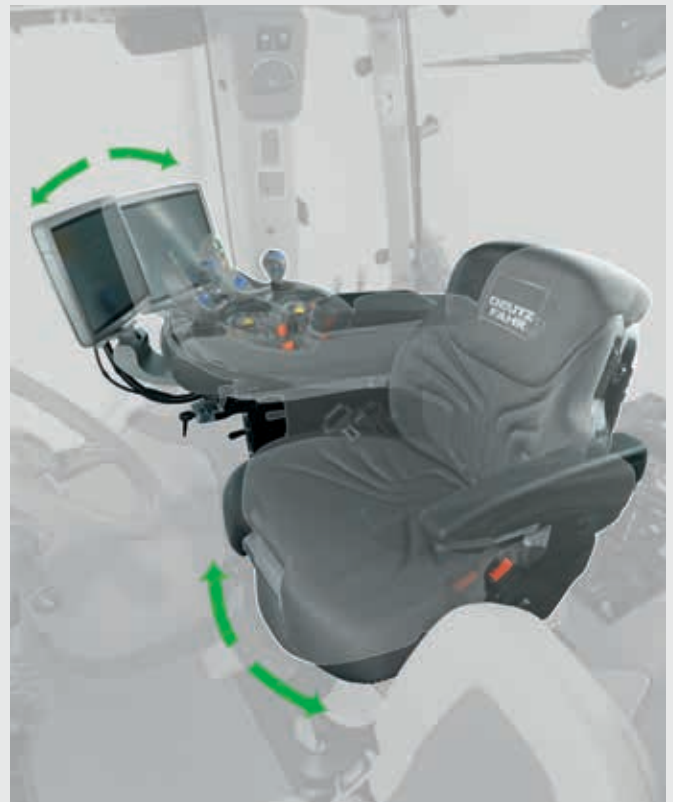
↑ Disponível para todos os modelos TTV: Banco com rotação até 23°, para maior conforto e facilidade de operação.
