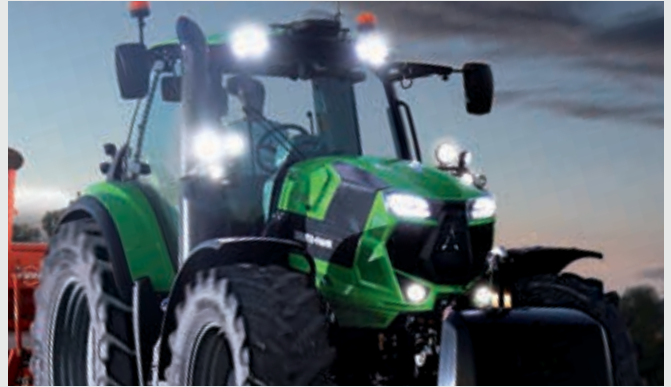
↑ Pack LED com até 2500 lm por farol de trabalho (consoante o modelo).
