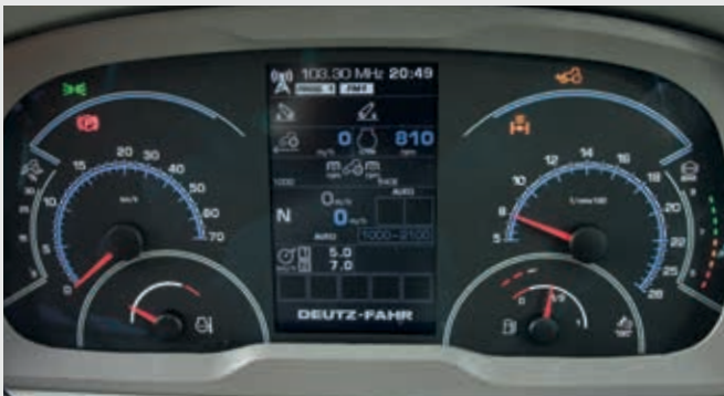
↑ Painel de instrumentos avançado com InfoCentre Pro : Ecrã de alta resolução de 5". O sistema iLock disponível garante segurança – bloqueio e desbloqueio do trator com PIN.
