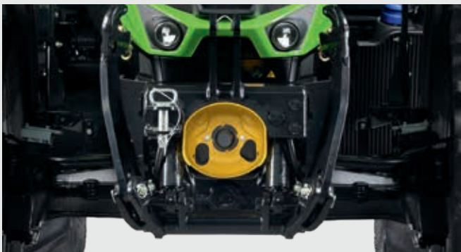
↑ Elevador dianteiro com controlo de posição e capacidade de elevação até 5450 Kg.
