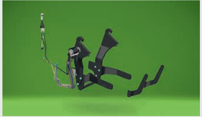
↑ Com o Light Kit ou o Ready Kit, as interfaces do carregador frontal estão já incluídas no trator.
