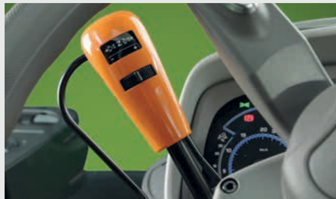
↑ PowerShuttle com SenseClutch e cinco níveis de regulação.
