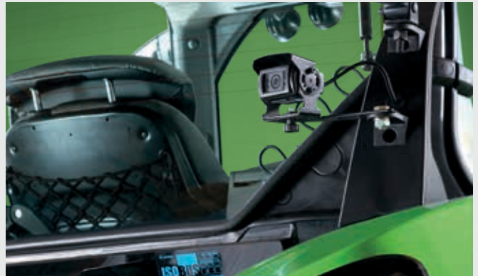
↑ Câmara integrada com modo de ecrã inteiro automático (por ex, marcha-atrás) para melhor perspetiva e segurança.
