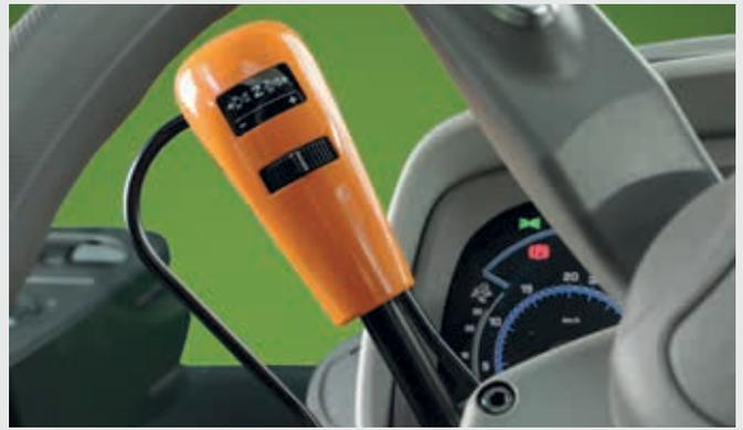
↑ PowerShuttle mit Sense-Kupplung und fünf Einstellungen.
