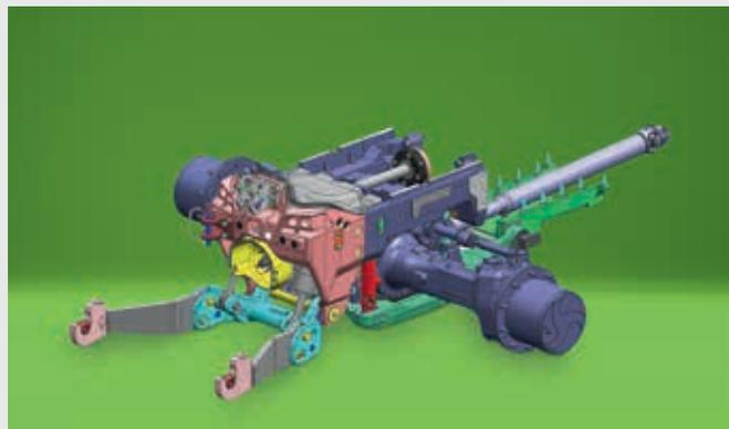
Elektronisch gesteuerte Federung mit Anti-Dive- und Anti-Rise-Regelung. Diese Federung kann sowohl auf dem Feld als auch auf der Straße eingesetzt werden. Bei Bedarf kann sie vollständig blockiert werden.
