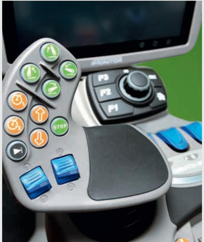
↑ Mit zwei Tasten auf dem MaxCom-Multifunktions-Joystick kann der Fahrer vier verschiedene Geschwindigkeitseinstellungen für Feldarbeit oder Straßeneinsatz wählen, um eine konstante Geschwindigkeit beizubehalten und so optimale Ergebnisse zu erzielen.
