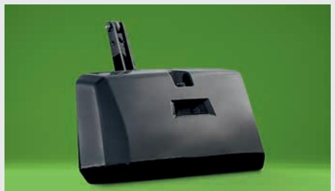
↑ Frontballast mit 1000 Kg Gusseisen für den Frontkraftheber.
