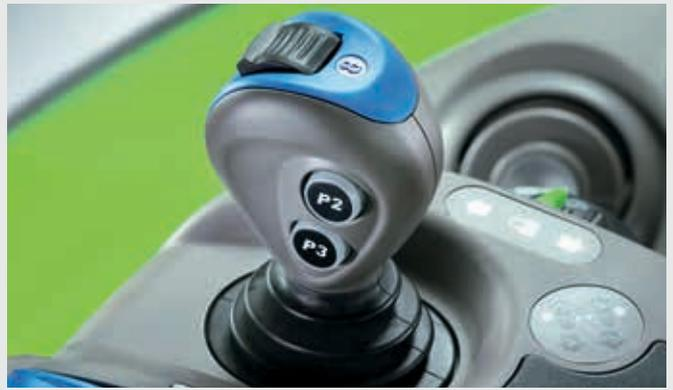
↑ Die Hydraulikventile sind mit einer Proportionalsteuerung ausgestattet und können in Bezug auf Zeit und Durchlaufmenge vollständig programmiert werden. Der elektronische Joystick kann für die Steuerung des Frontladers programmiert werden; die anderen Steuerventile können mit dem Daumenrad bedient werden.
