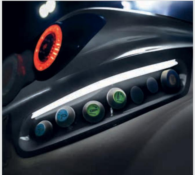
↑ LED-Beleuchtung der Bedienelemente am Kotflügel.
