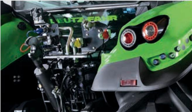
↑ Die Druckluftbremsanlage verzögert Anhänger aller Gewichtsklassen zuverlässig und sicher.
