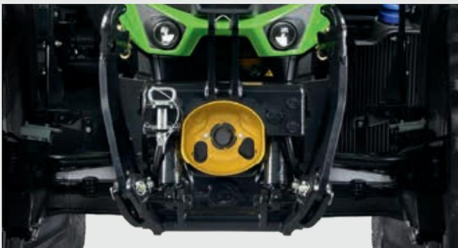
↑ Positionsgesteuerter Frontkraftheber mit bis zu 5450 Kg Hubkraft.
