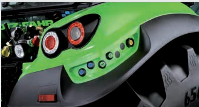
↑ Externe Bedienung der Hydraulikanlage, des Heckkrafthebers und der Zapfwelle von beiden Seiten aus.
