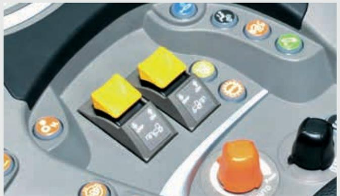
↑ Die Zapfwellensteuerung ist einfach und zuverlässig über einen Druckknopf zu bedienen.
