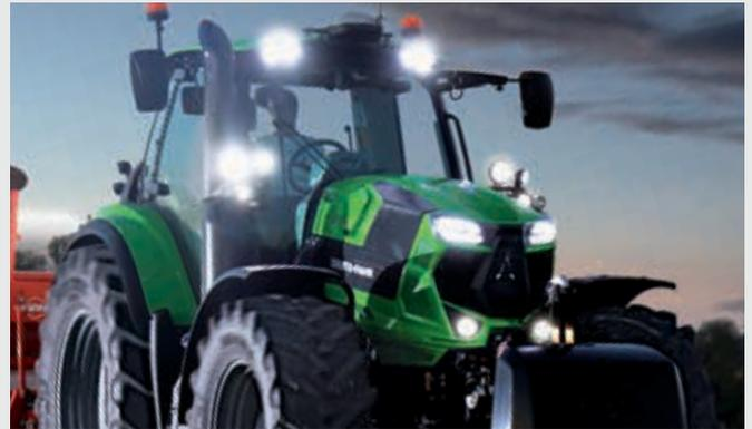
↑ Paquete de iluminación LED con hasta 2500 lm por faro de trabajo (según el modelo).
