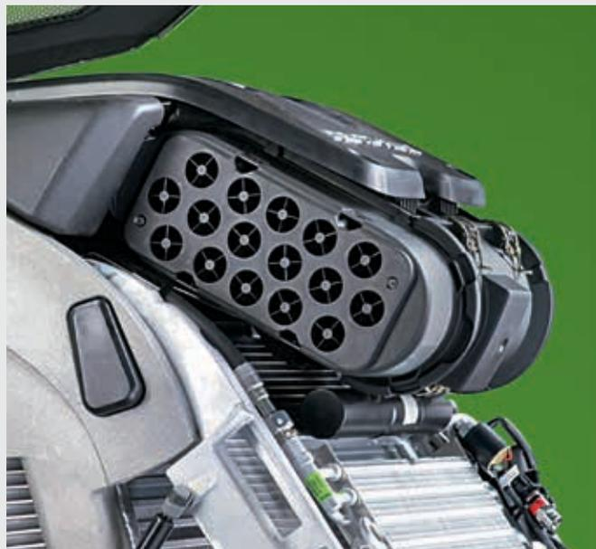
↑ Sistema de prelimpieza en el filtro de aire del motor: los tubos de ciclón en espiral y el tubo de aspiración eliminan el 95% del polvo antes de que entre en el filtro principal.
