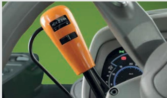
↑ Inversor hidráulico PowerShuttle con inversor regulable SenseClutch y cinco niveles de regulación.
