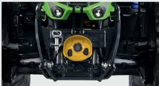
↑ Enganche frontal con control de posición y capacidad de elevación de hasta 5450 Kg.
