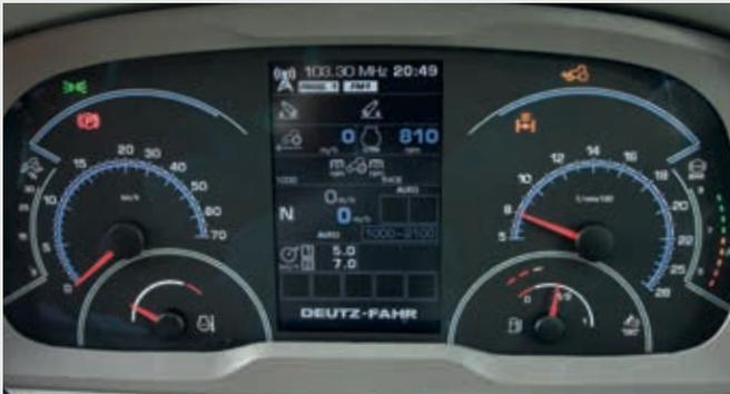
↑ Panel de instrumentos de última generación con InfoCentre<sup>Pro</sup>; Pantalla de 5" de alta resolución. Seguridad garantizada con el sistema iLock: el tractor se bloquea y se desbloquea con un PIN.
