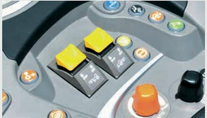
↑ La TDF se controla fácilmente y con total seguridad mediante un pulsador.
