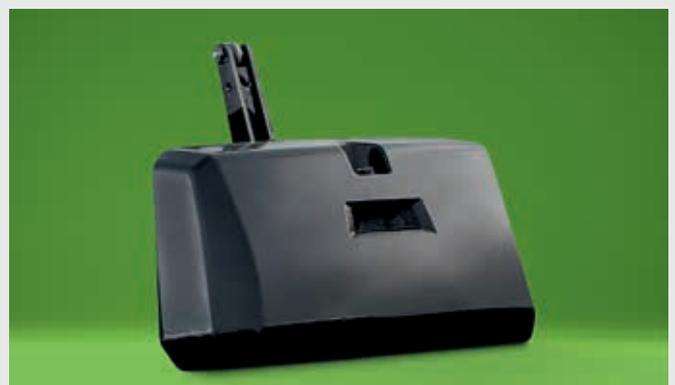
↑ Lastre delantero de hierro fundido con un peso de 1000 Kg para el enganche tripuntal delantero.
