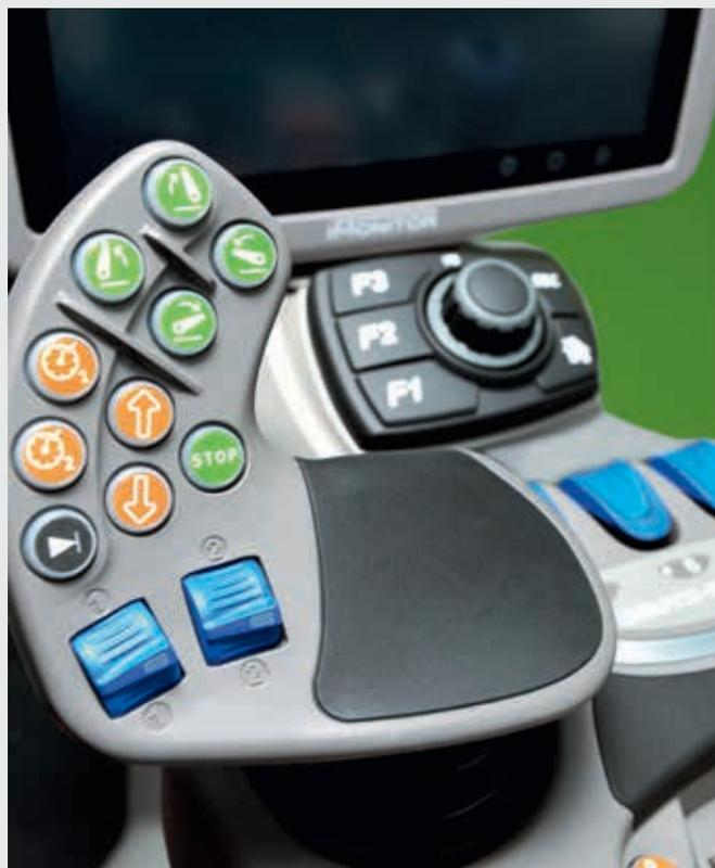
↑ Con solo dos botones del joystick MaxCom, el conductor puede activar fácilmente cuatro configuraciones de velocidad distintas, tanto en las aplicaciones del campo como en carretera, para mantener una velocidad constante y lograr los mejores resultados.
