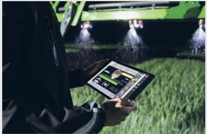
↑ Función XTEND con tableta, control de los implementos mediante ISOBUS UT estando fuera de la cabina.
