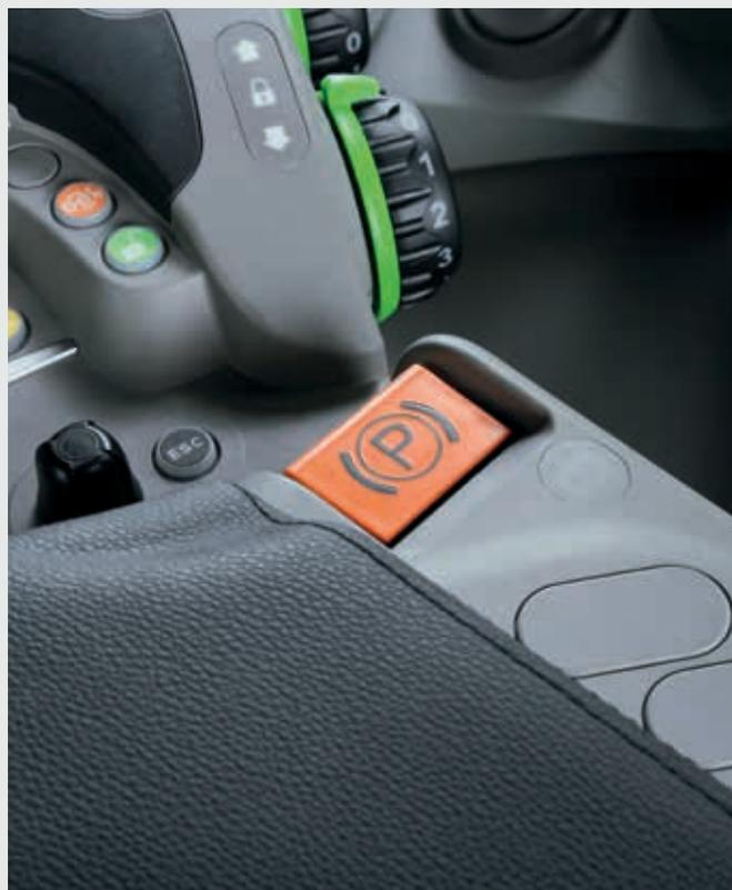
↑ El EPB sustituye a la palanca del freno de mano mecánico y se acciona mediante un pulsador electrónico situado en la consola del reposabrazos.
