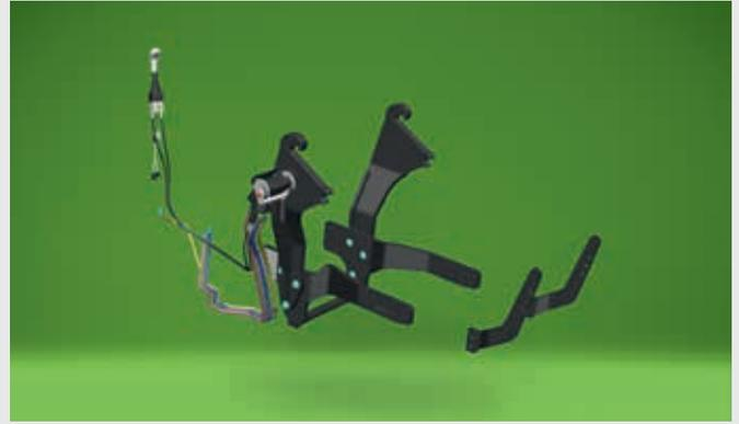
↑ Con el Light Kit o Ready Kit, las interfaces del cargador frontal ya están montadas en el tractor.
