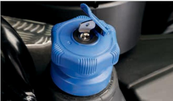
↑ Couvracles verrouillables pour réservoirs de carburant et AdBlue.
