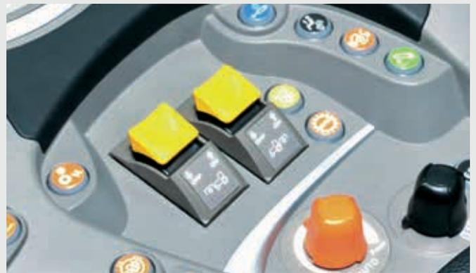
↑ La commande de la PDF est facile à utiliser et fiable grâce à un bouton poussoir.
