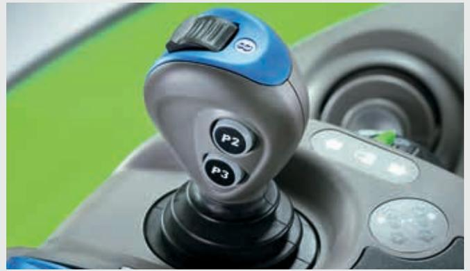
↑ Les distributeurs hydrauliques sont équipés d'une commande proportionnelle et peuvent être entièrement programmés en fonction du temps et de la quantité. Le joystick électronique peut être programmé pour commander le chargeur frontal tandis que d'autres distributeurs sont actionnés à l'aide de la molette.
