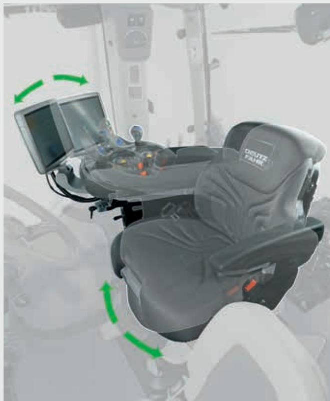
↑ Disponible pour tous les modèles TTV : siège pivotant jusqu'à 23° pour plus de confort et de facilité d'utilisation.
