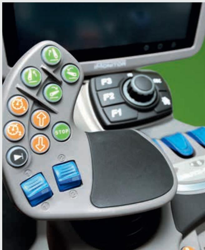
↑ Avec deux boutons sur le joystick multifonction MaxCom, le conducteur peut utiliser quatre vitesses différentes pour travailler dans les champs ou pour l'application sur route en vue de maintenir une vitesse constante pour un résultat optimal.
