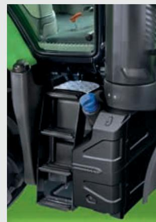
↑ Les modèles 6 cylindres proposent des goulots de remplissage du réservoir des deux côtés pour une commodité accrue.
