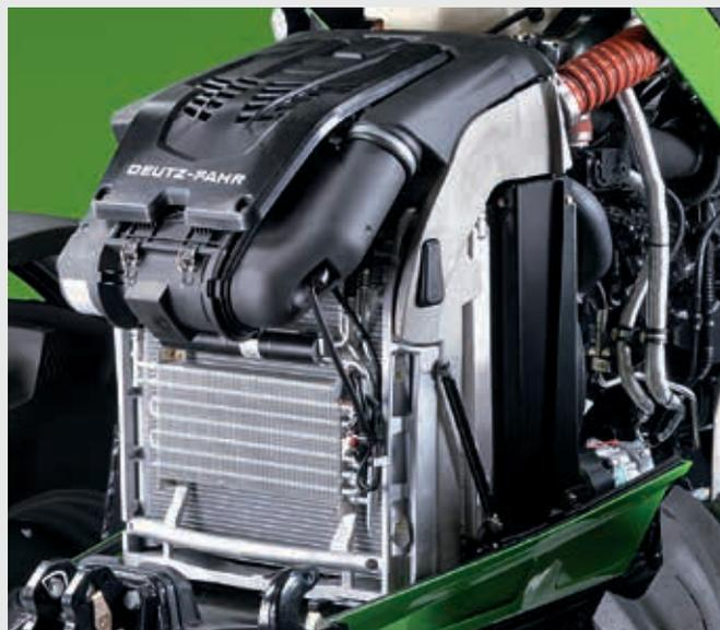
↑ Technologie PowerCore pour filtre à air : 20 % de capacité de débit d'air en plus par rapport aux filtres standard.
