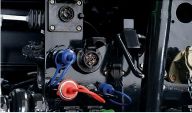
↑ Les interfaces ISOBUS DEUTZ-FAHR à l'avant et à l'arrière rendent le tracteur compatible avec les outils de tous les fabricants renommés.
