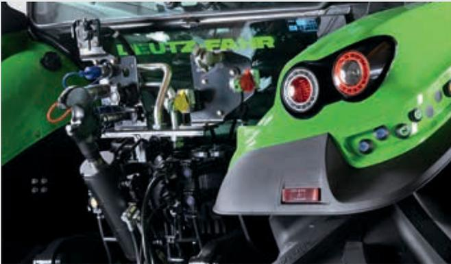
↑ Le système de freinage à air comprimé ralentit les remorques dans toutes les catégories de poids de manière fiable et sûre.
