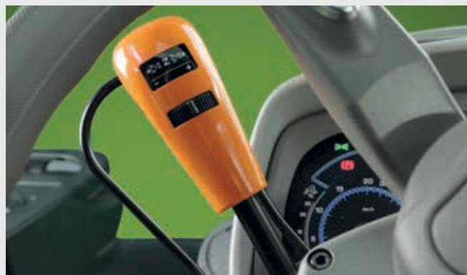
↑ Inverseur avec SenseClutch et cinq niveaux de réglage.
