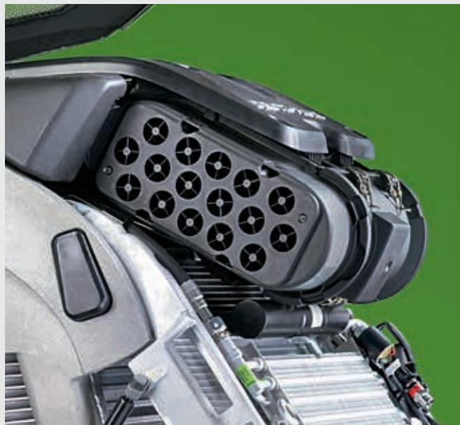
↑ Système de pré-nettoyage dans le filtre à air du moteur : les tuyaux cyclones en spirale et les tuyaux d'aspiration éliminent 95 % des poussières avant qu'elles n'atteignent le filtre primaire.
