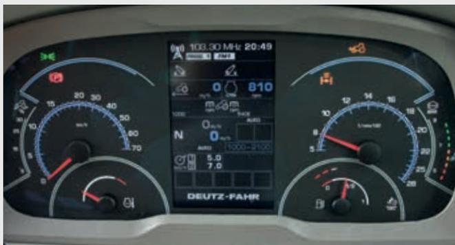
↑ Tableau de bord de point avec InfoCentre<sup>Pro</sup> : écran 5" à haute résolution. Le système de verrouillage iLock assure sécurité et permet de verrouiller et déverrouiller le tracteur avec un code PIN.
