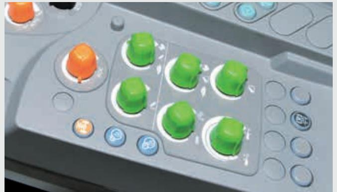
↑ Le relevage avant et le relevage arrière peuvent être réglés avec précision à l'aide de potentiomètres sur l'accodoir.
