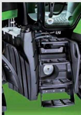
↑ Marchepied d'accès confortable intégré au réservoir de carburant.
