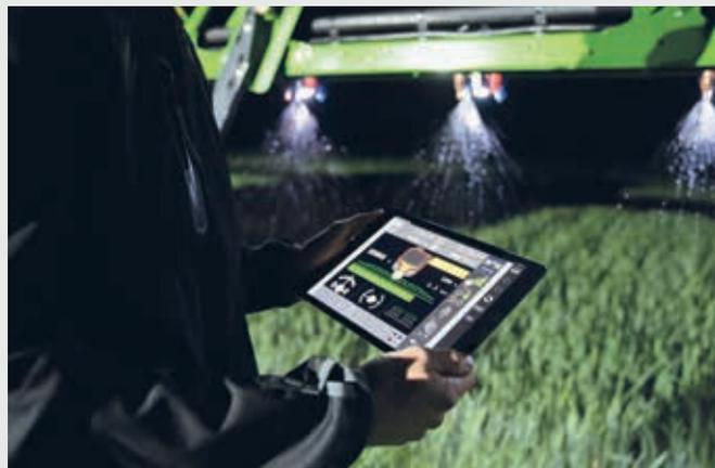
↑ Fonction XTEND avec tablette, contrôle des outils via ISOBUS UT tout en étant hors cabine.
