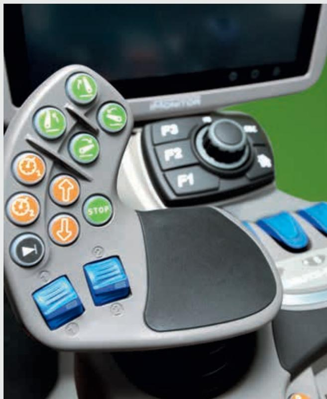
↑ Con due pulsanti sul joystick multifunzione MaxCom, l'operatore può impostare quattro diverse velocità per il lavoro sul campo o per le applicazioni su strada, e mantenere una velocità costante per risultati ottimali.
