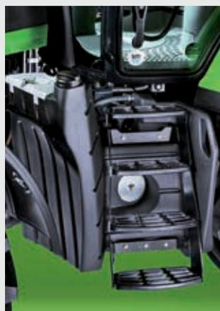
Comodi gradini di accesso integrati nel serbatoio carburante.
