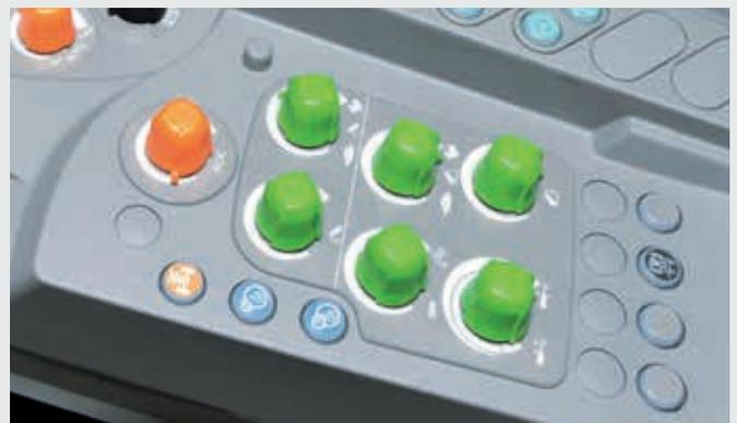
↑ Il comando del sollevatore anteriore e del sollevatore posteriore può essere regolato con precisione dai potenziometri sul bracciolo.
