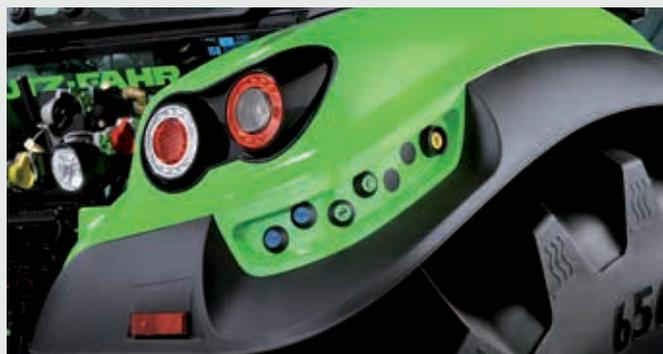
↑ Facile utilizzo di impianto idraulico, sollevatore posteriore e PTO da remoto da entrambi i lati.
