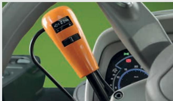
↑ Inversore PowerShuttle con SenseClutch e cinque livelli di configurazione.
