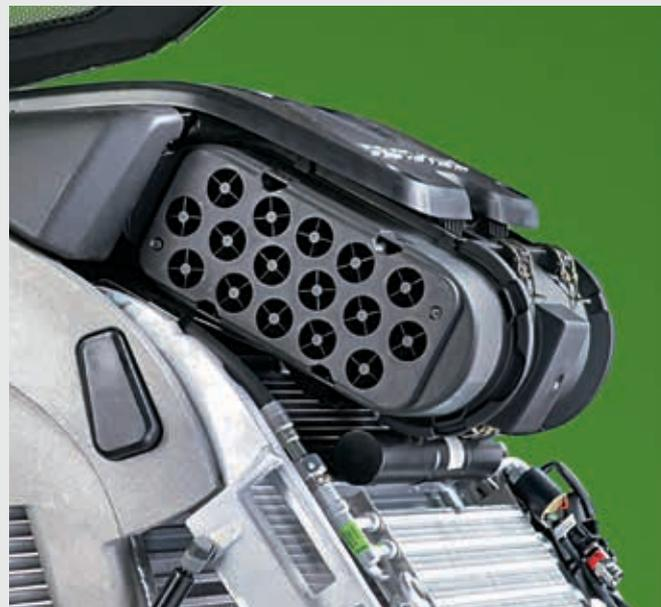
↑ Sistema di pulizia nel filtro aria motore: tubi ciclonici a spirale e un tubo flessibile dell'aspiratore eliminano il 95% della polvere prima del suo passaggio al filtro primario.
