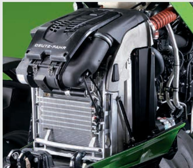
↑ Tecnologia PowerCore per il filtro dell'aria: portata d'aria del 20% superiore a quella degli analoghi filtri standard.
