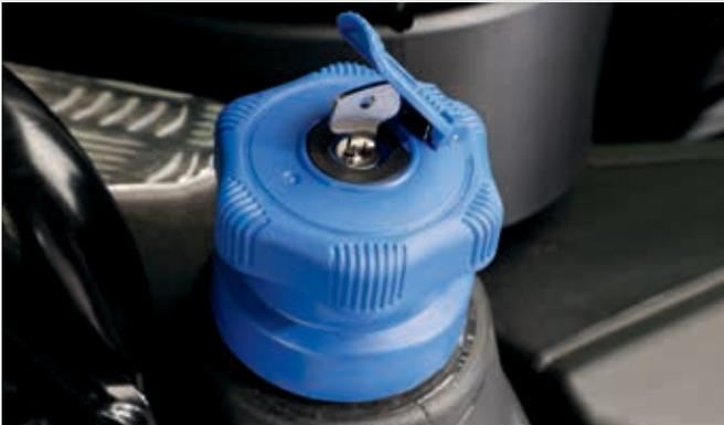
Tappi per serbatoi carburante e AdBlue con serrature di bloccaggio.
