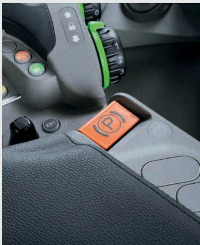
↑ L'EPB sostituisce la leva del freno di stazionamento meccanico ed è azionato mediante un comando a pulsante elettrico sulla plancia del bracciolo.
