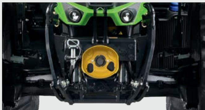
↑ Sollevatore anteriore con posizione controllata con capacità di sollevamento massima di 5450 Kg.
