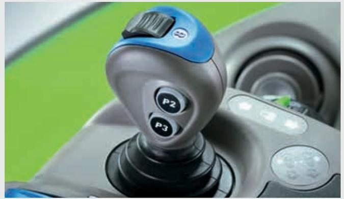
↑ I distributori idraulici sono dotati di controllo proporzionale con possibilità di programmare tempi e quantità. Il joystick elettronico può essere programmato per comandare il caricatore frontale, mentre altri distributori del trattore sono azionabili con la manopola.
