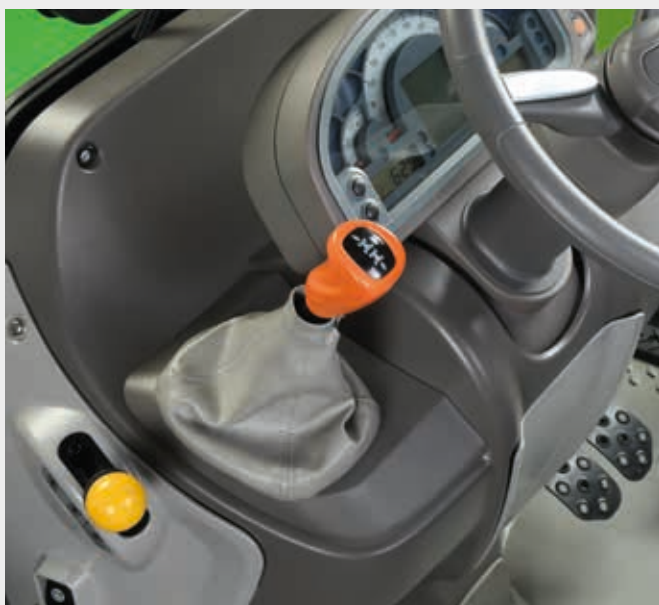
⬆ Mechanische omkeerinrichting met ergonomische hendel op de stuurkolom.
