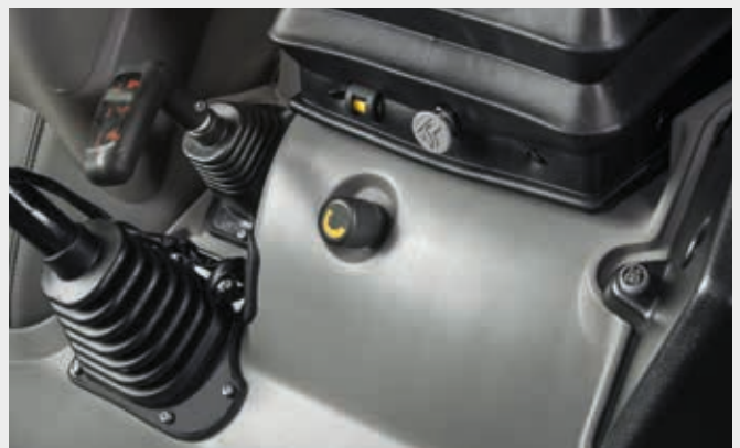
⬆️ Doorstroomregeling in cabine.
