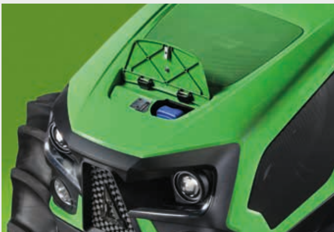
↑ Gemakkelijk bereikbare AdBlue-tank.
