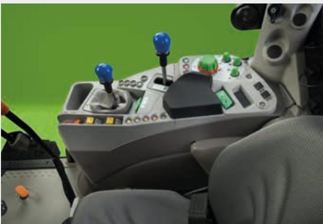
↑ Achterste hydrauliekventielen bediend door enkele hendels of mechanische kruishendel.
