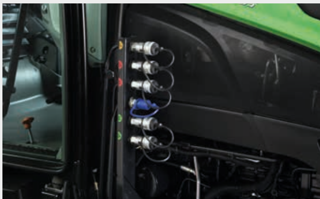
↑ Tot 5 midden gemonteerde hydraulische leidingen.
