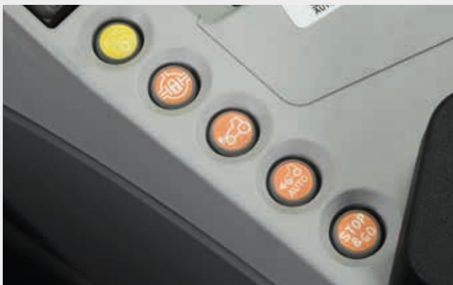
De automatische vierwielaandrijving wordt automatisch in- en uitgeschakeld op basis van stuurhoek en snelheid.
