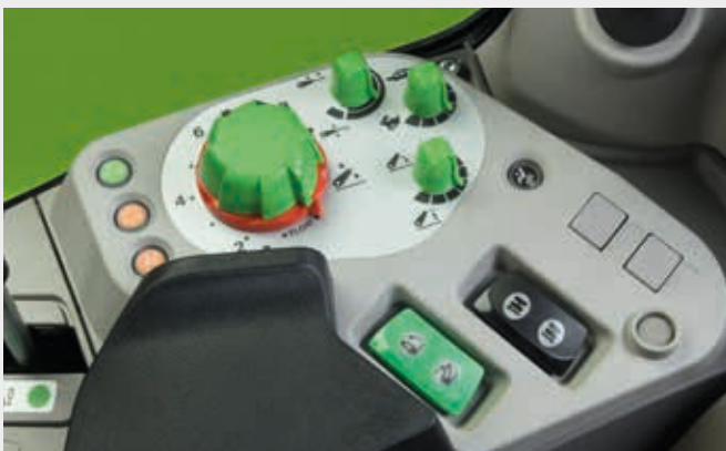
⬆️ Nauwkeurige trekkracht- en positieregeling dankzij de elektronische hefinrichting achter op cabineversies.
