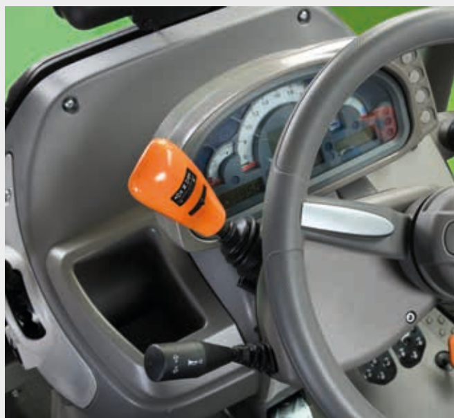
⬆ PowerShuttle met SenseClutch met 5 instelbare niveaus.
