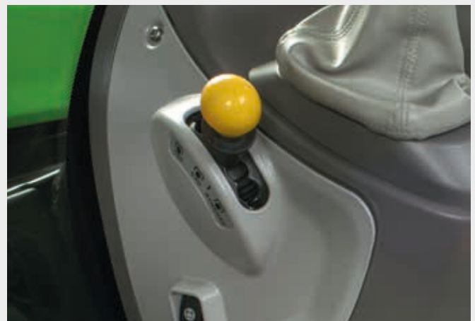
↑ Keuzeschakelaar aftakstoerental in de cabine.
