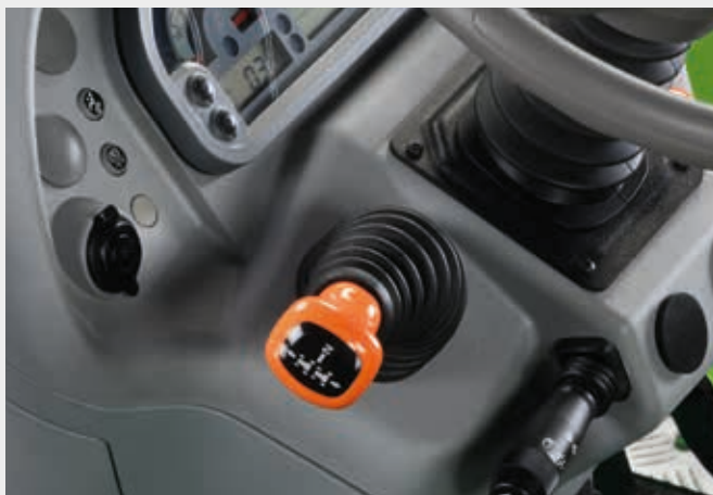
↑ Hendel voor ergonomische omkeerinrichting onder het stuurwiel.
