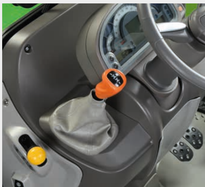
↑ Inversor mecânico com alavanca ergonômica na coluna de direção.
