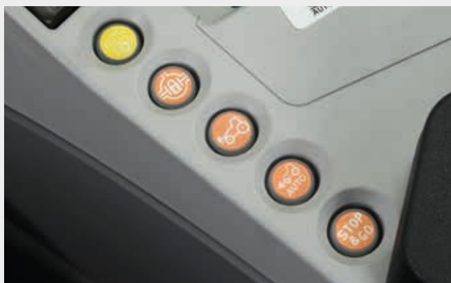
↑ A função Auto 4WD permite engatar e desengatar automaticamente a 4WD de acordo com o ângulo de viragem e a velocidade.
