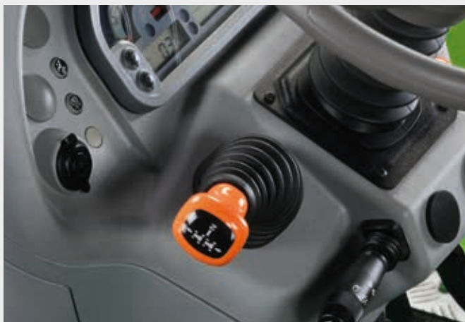
↑ Alavanca ergonómica do inversor por baixo do volante.
