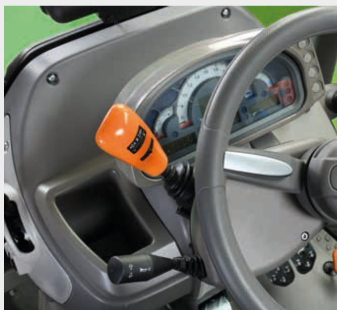
↑ PowerShuttle com 5 níveis de regulação SenseClutch.
