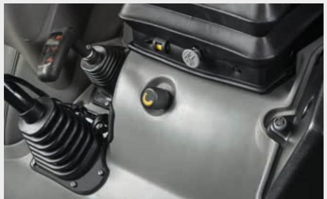
⬆ Regulador de fluxo na cabina.
