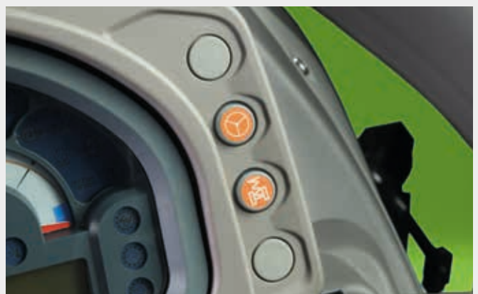
A função SDD reduz para metade o número de viragens do volante necessárias para a direção bloqueio a bloqueio.
