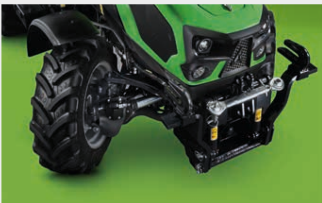
Grande ângulo de viragem graças à suspensão independente da ponte dianteira.
