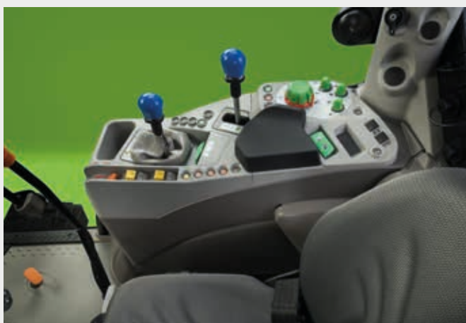
↑ Distribuidores traseiros controlados por alavancas simples ou alavanca transversal mecânica.
