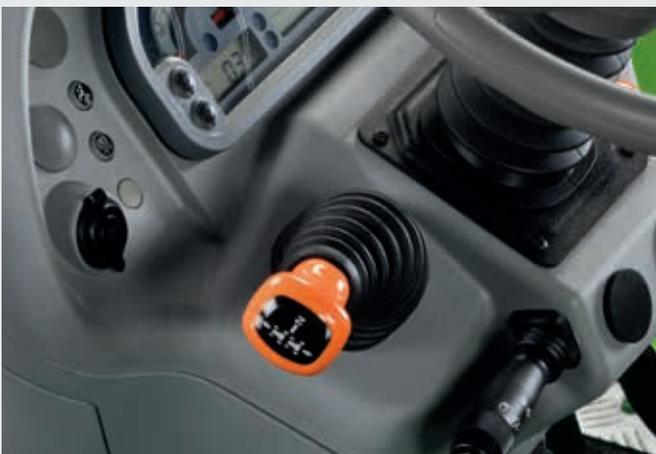
↑ Ergonomischer Wendeschalthebel unter dem Lenkrad.
