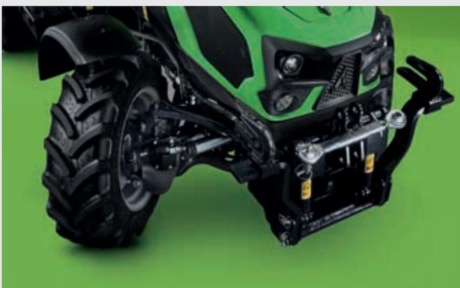
↑ Hoher Lenkeinschlagswinkel dank Einzelradaufhängung vorne.
