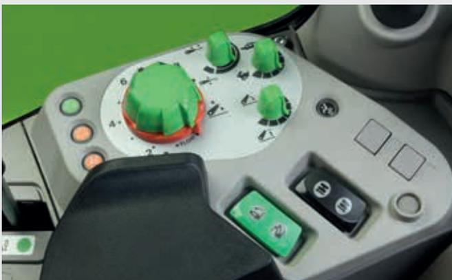
↑ Präzise Zugkraft- und Positionskontrolle dank elektronischem Heckkraftheber bei Kabinen-Ausführungen.
