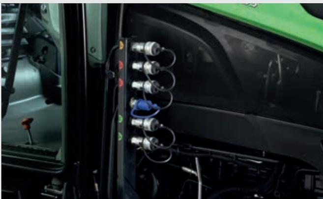
↑ Bis zu fünf Hydraulikanschlüsse im Zwischenachsbereich.
