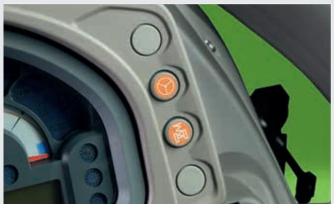
↑ Die SDD-Funktion halbiert die Lenkraddrehungen von Lenkanschlag zu Lenkanschlag.
