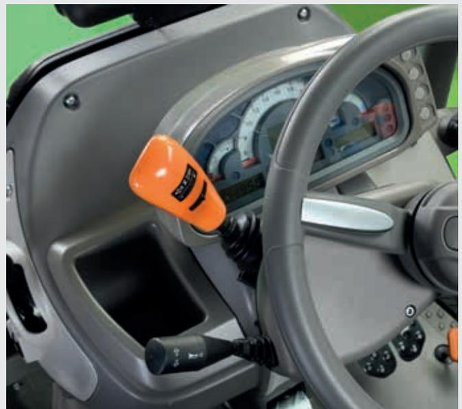
↑ PowerShuttle mit SenseClutch (5 Einstellstufen).
