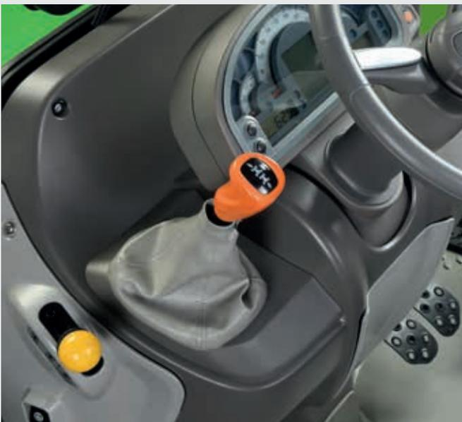
↑ Mechanisches Wendegetriebe mit ergonomischem Hebel an der Lenksäule.
