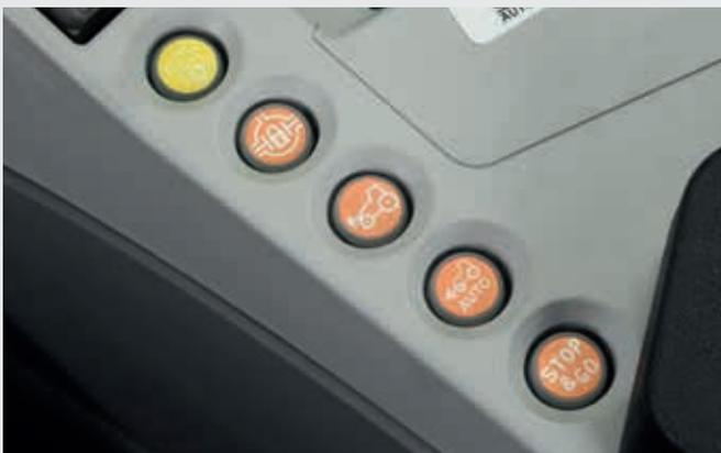
Die automatische Allradzuschaltung ermöglicht das automatische Zuschalten und Trennen des Allradantriebs je nach Lenkeinschlagswinkel und Geschwindigkeit.
