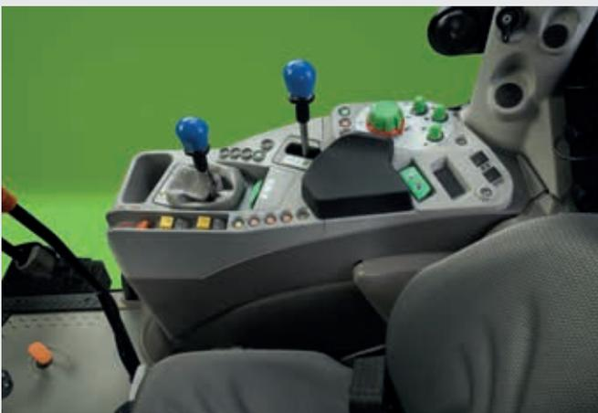
↑ Die hinteren Steuerventile werden mit einzelnen Hebeln oder einem mechanischen Kreuzhebel betrieben.
