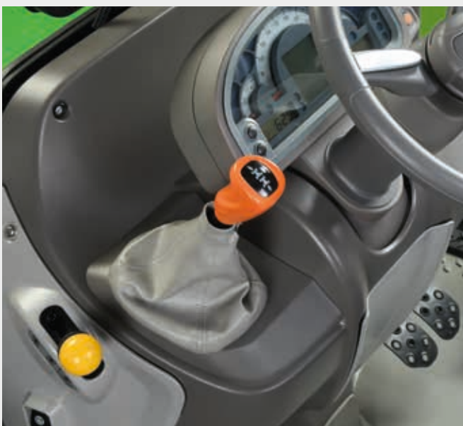
⬆ Inversor mecánico con palanca ergonómica en la columna de dirección.
