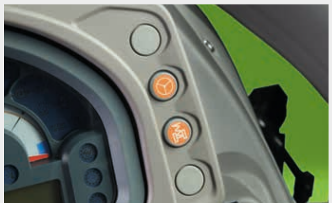
↑ La función SDD reduce a la mitad el número vueltas para dar un giro completo del volante.
