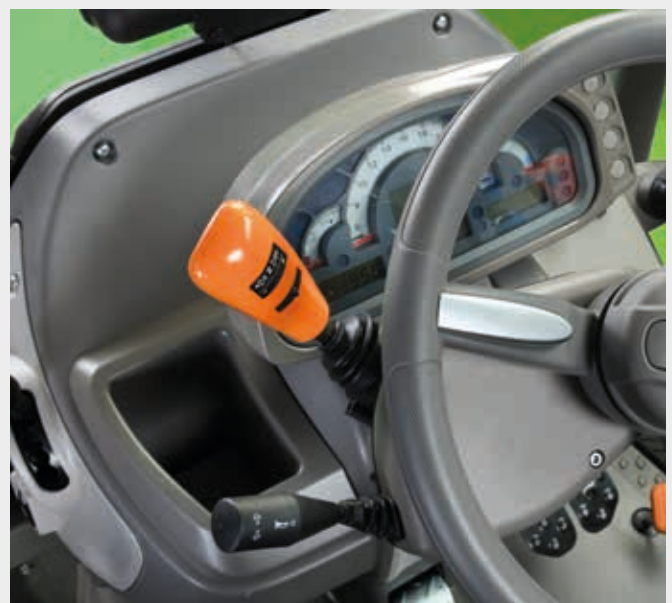
⬆ Inversor electrohidráulico con SenseClutch y 5 niveles de ajuste.
