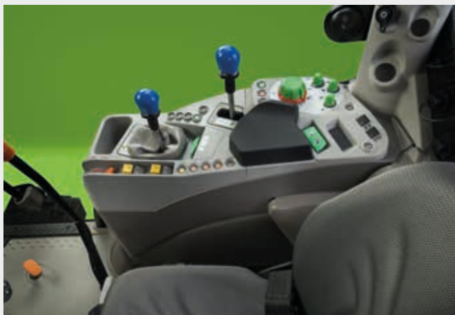
↑ Distribuidores traseros controlados por palancas simples o mecánicas en cruz.
