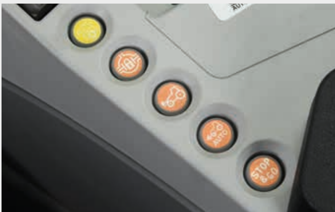
La función de gestión automática de la doble tracción permite acoplar y desacoplar automáticamente la tracción integral en función del ángulo de giro y la velocidad.
