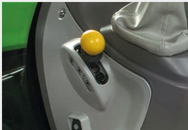
↑ Selector de velocidad de la TDF en la cabina.
