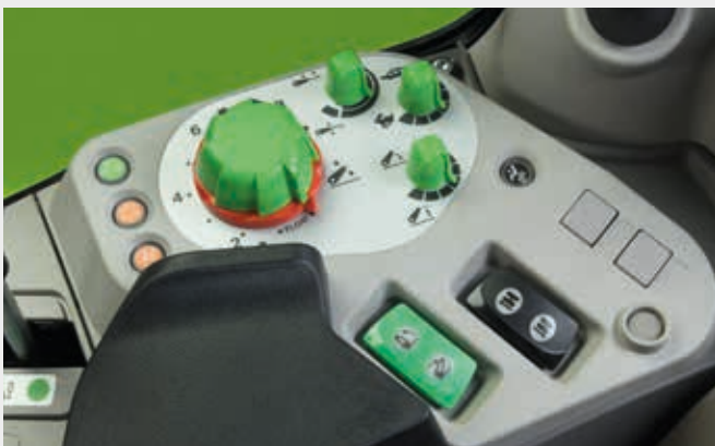
↑ Gran precisión del control de la tracción y de la posición gracias al elevador trasero electrónico en las versiones con cabina.
