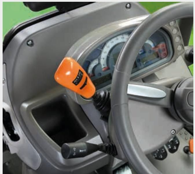
⬆ PowerShuttle con SenseClutch con 5 livelli di regolazione.
