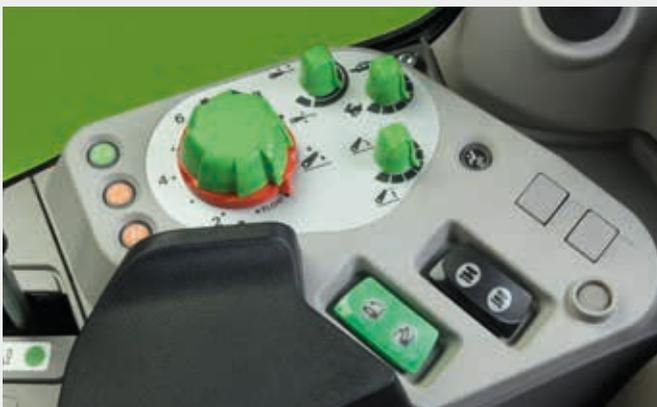
↑ Preciso controllo di sforzo e posizione grazie al sollevatore posteriore elettronico sulle versioni con cabina.
