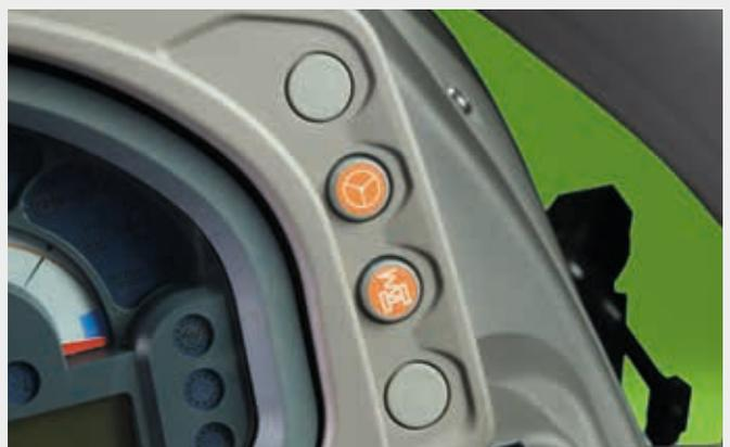
↕ La funzione SDD dimezza il numero di giri del volante necessari per passare da un arresto di fine sterzata all'altro.
