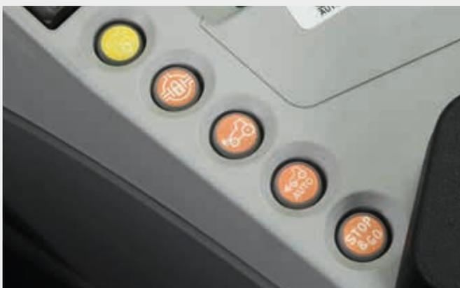
La funzione Auto 4RM consente l'innesto e il disinnesto automatico della trazione integrale in funzione di angolo di sterzata e velocità.
