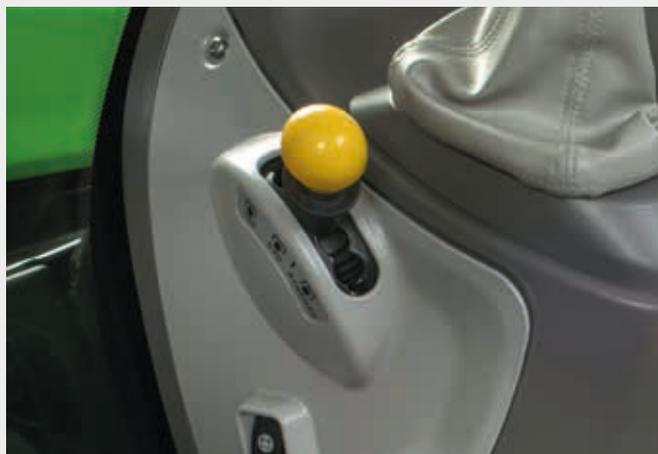
↑ Selettore velocità PTO in cabina.
