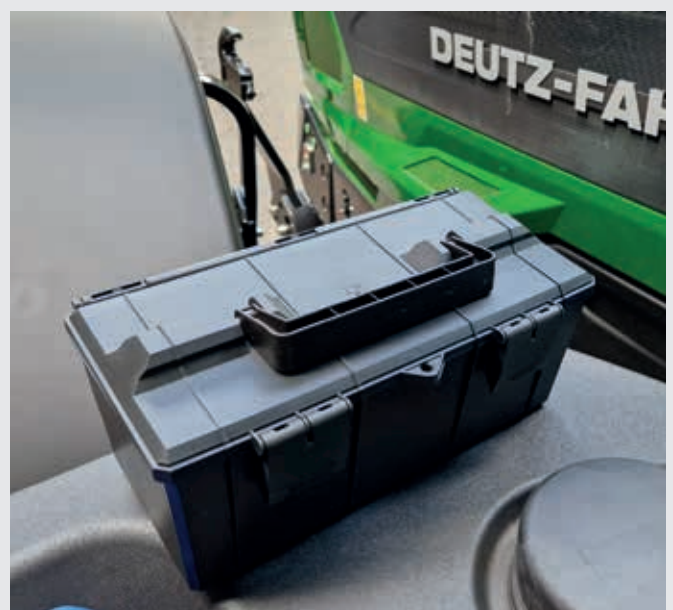
↑ Opbergvak boven de brandstoftank aan de linkerkant voor luchtslang en luchtpistool.
