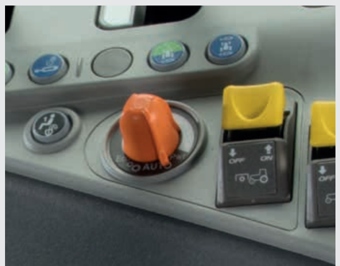
↑ Eenvoudig en intuïtief - met de Eco/Power-instelknop kan de bestuurder het schakelgedrag van APS (Automatic PowerShift) wijzigen.
