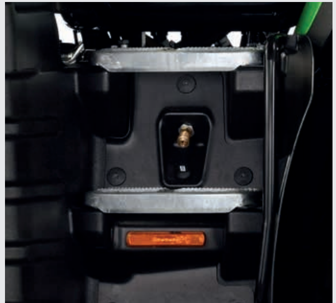
↑ Luchtaansluiting en lichtschakelaar beschermd onder de treden.
