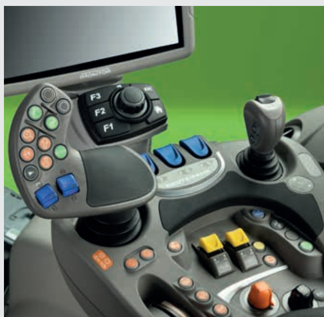
Om de elektrische hydrauliekventielen te bedienen, kan de bestuurder kiezen uit de blauwe vingertopbediening, de kleine joystick of de handige duimwielen op de MaxCom-joystick.
