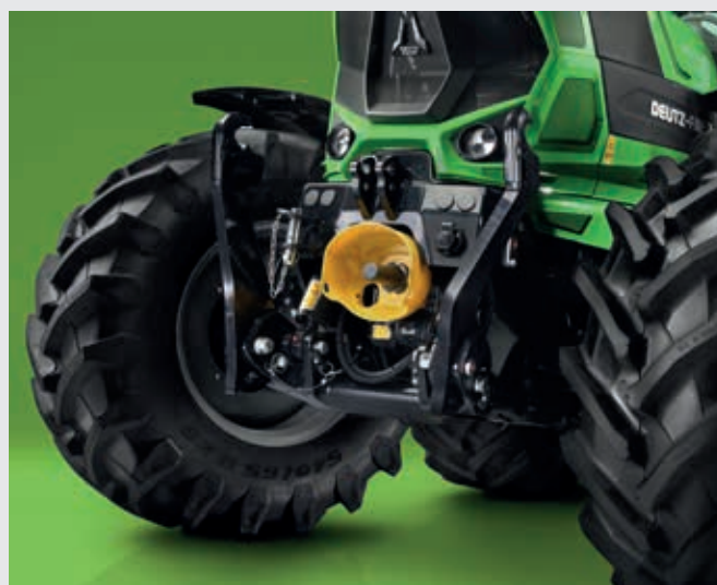
↑ Efficiënte fronthefinrichting met maximaal 3800 kg hefvermogen en optionele 1000 frontaftakas.
