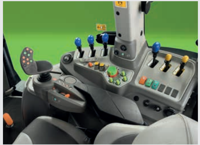
De uitrusting voor de MaxiVision-cabine met volledig mechanische hydrauliekventielen achter is beschikbaar voor Powershift- (grote afbeelding) en RCshift-modellen (afbeelding boven).
