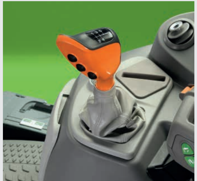
↑ Ergonomische versnellingshendel met knoppen voor ComfortClutch, APS en Powershift.
