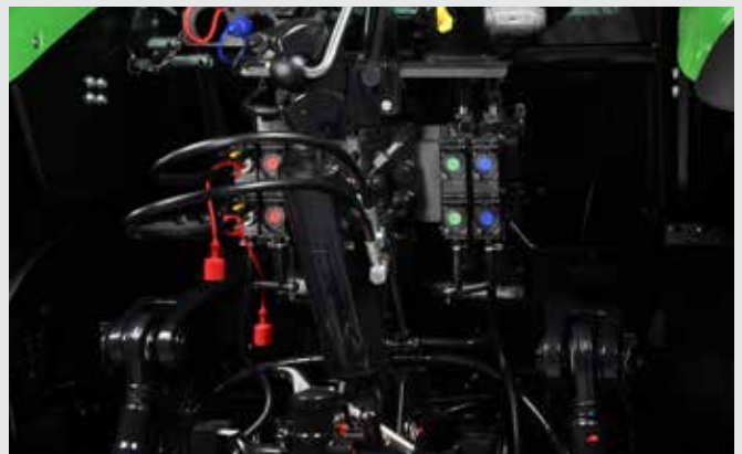
↑ Hoog comfort gecombineerd met gebruiksgemak: gemengde hydraulische configuratie met twee elektrische en twee mechanische ventielen.
