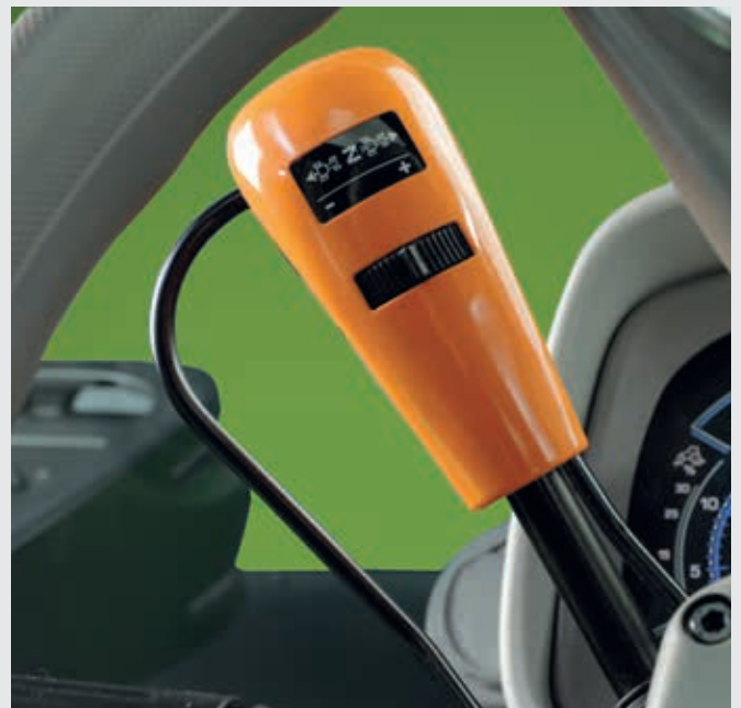
↑ Ergonomische PowerShuttle-hendel met instelknop voor SenseClutch.
