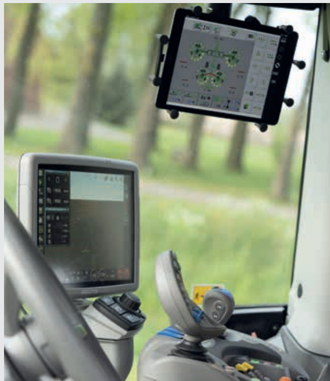
Funkcja XTEND umożliwia wyświetlanie funkcji SDF Guidance lub pozwala kontrolować maszynę w ISOBUS za pomocą zewnętrznego urządzenia, np. tabletu.
