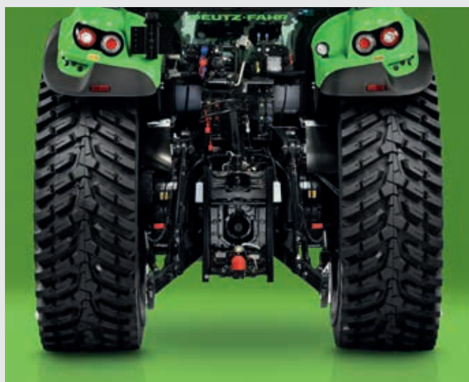
↑ Tylny podnośnik o udźwigu do 9700 kg.
