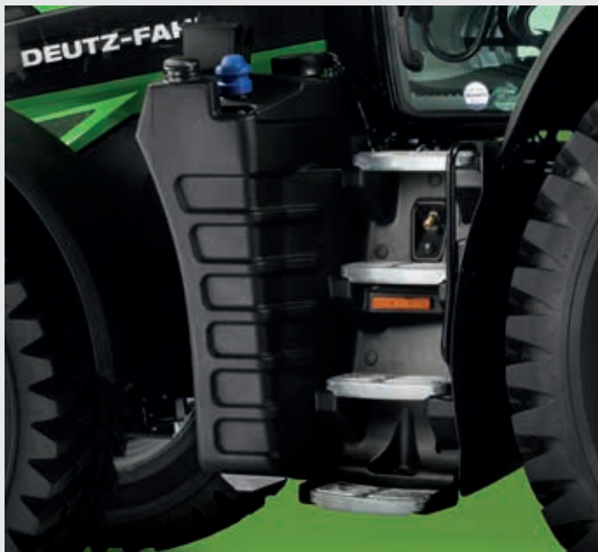
↑ Zbiornik paliwa o pojemności do 410 litrów na najdłuższy czas nieprzerwanej pracy.
