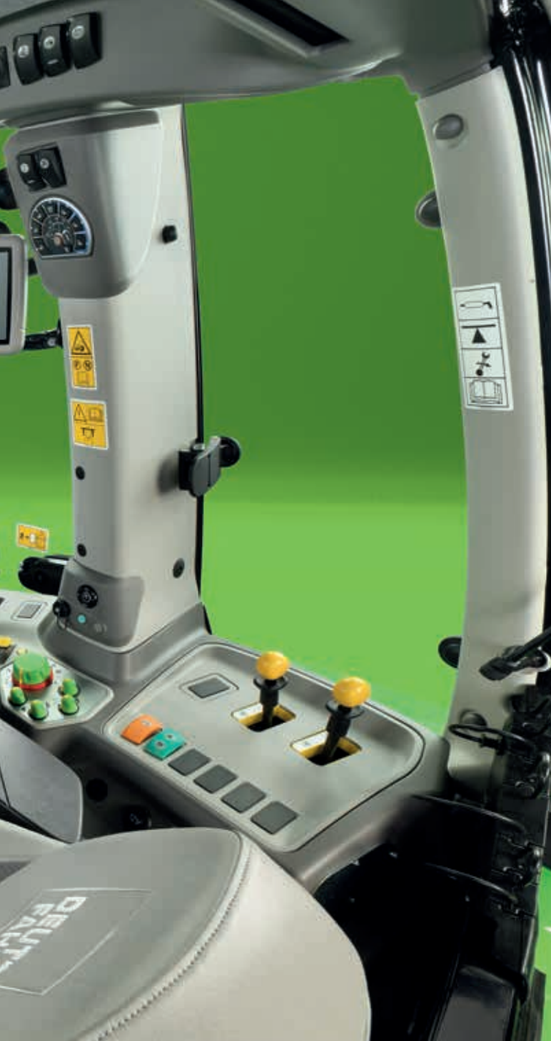
↑ Wyposażenie nowej kabiny MaxiVision+, z konfiguracją mieszanych tylnych obwodów, jest dostępne w modelach z przekładnią Powershift (duże zdjęcie) i RCshift (zdjęcie powyżej).
