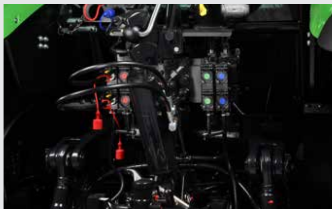
↑ Wysoki komfort połączony z łatwością obsługi: mieszana konfiguracja hydrauliczna z dwoma rozdzielaczami sterowanymi elektronicznie i dwoma mechanicznie.
