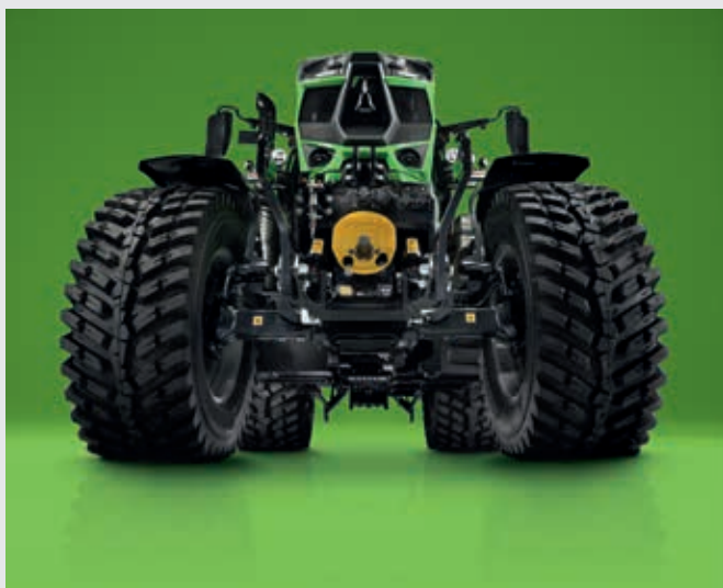
↑ Przedni podnośnik o udźwigu 5450 kg oraz opcjonalny przedni WOM DualSpeed.
