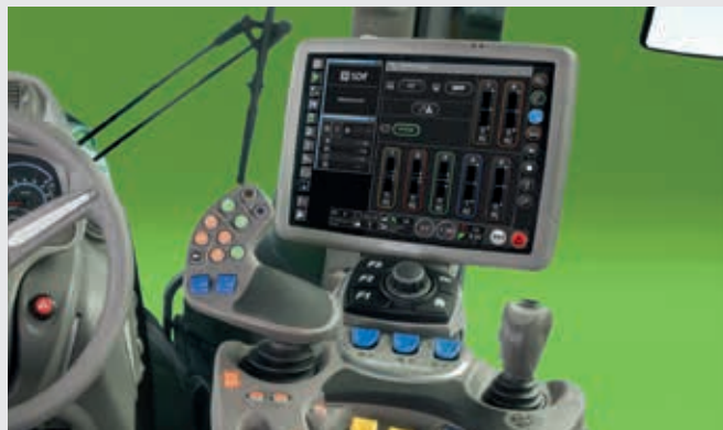
↑ Rozdzielacze sterowane elektronicznie z wygodnymi elektronicznymi przełącznikami.
