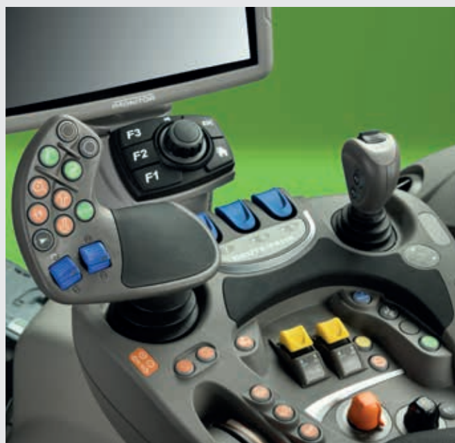
↑ Operator steruje hydrauliką ciągnika za pomocą przełączników na joysticku, podłokietniku lub za pomocą małego joysticka.
