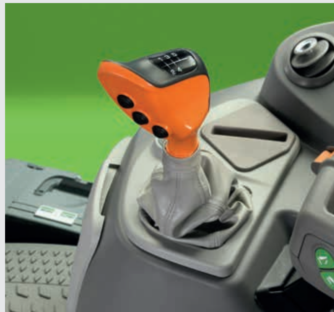
↑ Ergonomiczna dźwignia zmiany biegów z przyciskami ComfortClutch, APS i Powershift.
