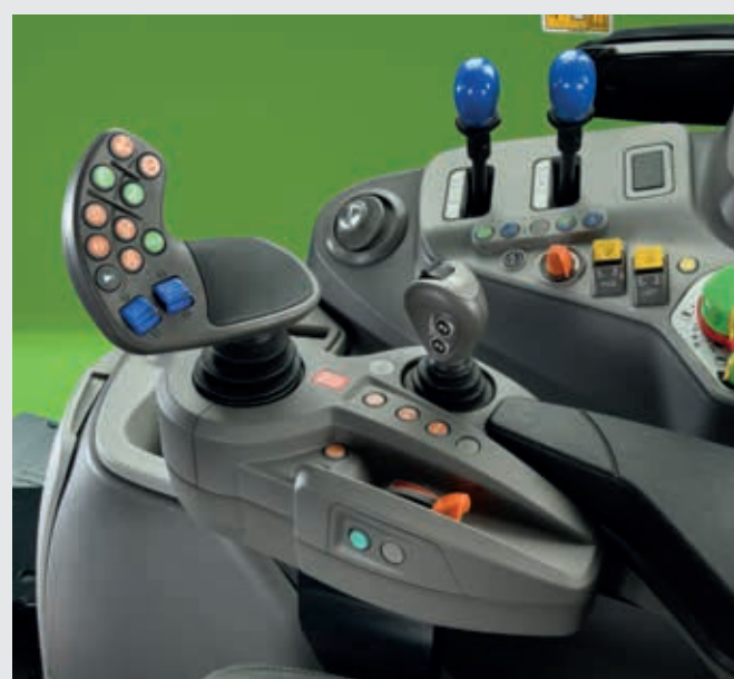
↑ Pokrętła na joysticku MaxCom i dwie dźwignie mechanicznego sterowania obwodami. Joystick krzyżowy może być używany do sterowania ładowniczem czołowym.
