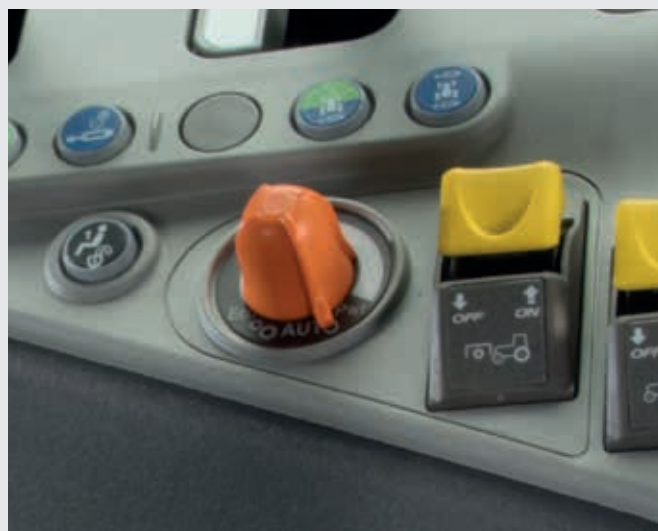
↑ Prosta i intuicyjna obsługa – za pomocą pokrętki regulacji Eco/Power operator może zmienić działanie funkcji APS (automatycznej zmiany pól biegów Powershift).
