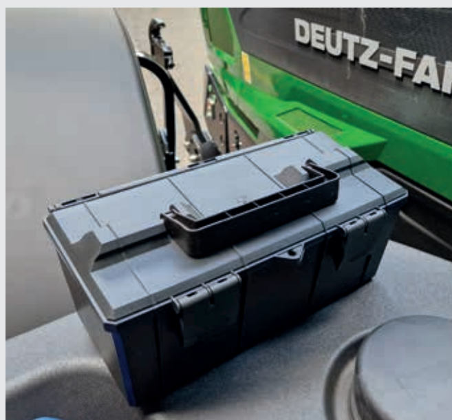
↑ Schowek nad zbiornikiem paliwa po lewej stronie na przewód powietrza i pistolet pneumatyczny.
