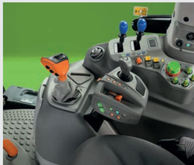
↑ Wyposażenie nowej kabiny MaxiVision+, z konfiguracją mieszanych tylnych obwodów, jest dostępne w modelach z przekładnią Powershift (duże zdjęcie) i RCshift (zdjęcie powyżej).
