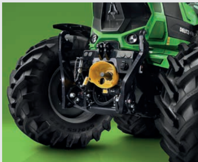
↑ Wydajny przedni podnośnik o udźwigu 3800 kg oraz opcjonalny przedni WOM 1000.
