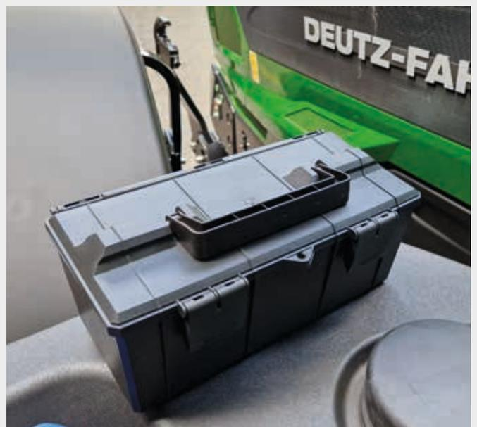
↑ Caixa de armazenamento por cima do depósito de combustível no lado esquerdo para mangueira de ar e pistola de ar comprimido.
