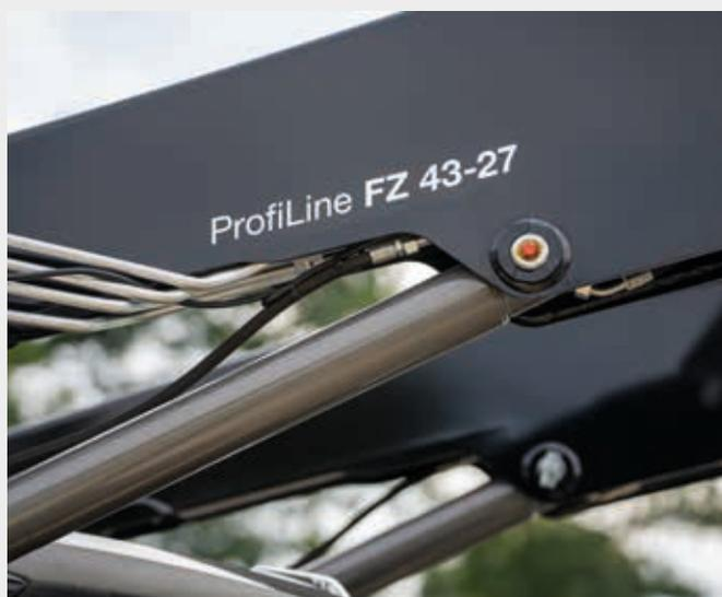
↑ Os novos carregadores frontais ProfiLine integram todas as linhas hidráulicas dentro dos montantes para garantir que estão bem protegidas e o condutor tem uma visão desobstruída.
