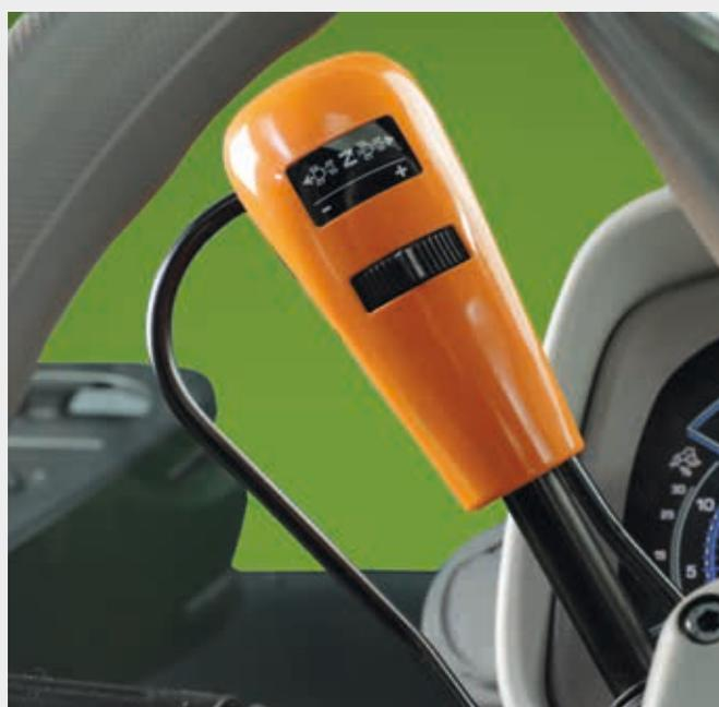
Alavanca PowerShuttle ergonómica com seletor de ajuste SenseClutch.
