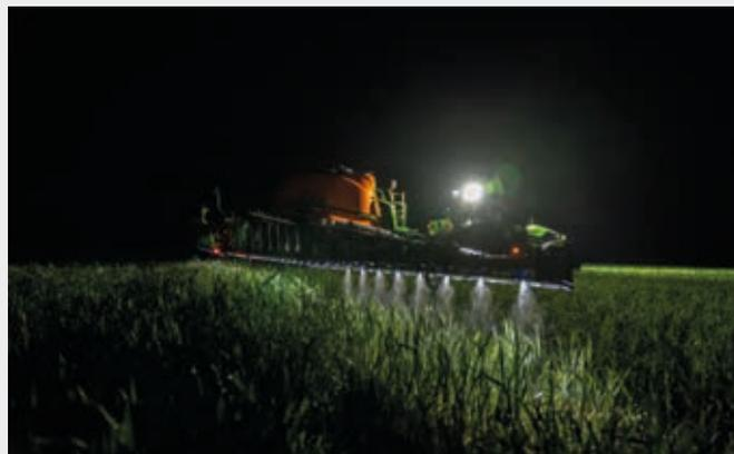
Com o controlo automático de secções e um pulverizador com controlo de bico único, é possível poupar nos agentes fitossanitários. O controlo automático de secções com até 200 secções é uma função de série no iMonitor.
