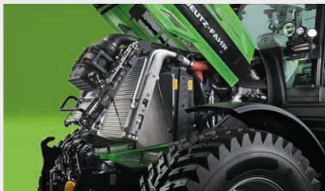
↑ Sistema de refrigeração em alumínio do 6210 e 6230 com alavanca de acesso a uma mão e filtro de ar Powercore com sistema de pré-limpeza ciclônico opcional.
