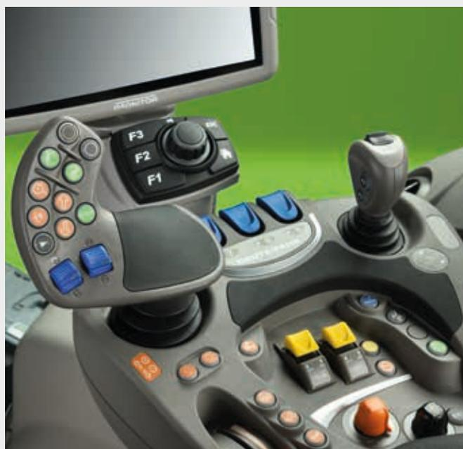
↑ Para controlar os distribuidores elétricos, o operador pode escolher entre os controles azuis na ponta dos dedos, o pequeno joystick ou as práticas rodas seletoras no joystick MaxCom.
