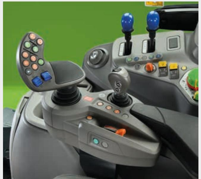
↑ As rodas seletoras no joystick MaxCom e as duas alavancas mecânicas controlam os distribuidores traseiros, enquanto a alavanca cruzada pode ser utilizada para controlar o carregador frontal.
