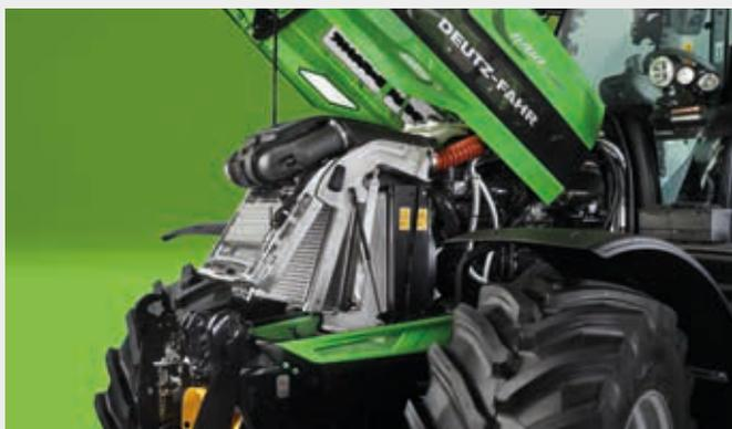
↑ Sistema de refrigeração em alumínio do 6160.4 - 6190 com alavanca de acesso a uma mão e filtro de ar Powercore com sistema de pré-limpeza ciclônico.
