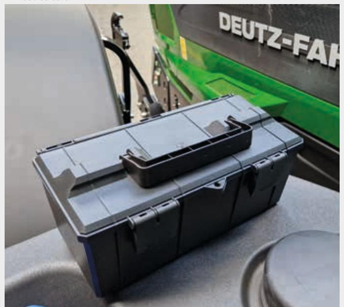
↑ Caja de almacenamiento sobre el depósito de combustible, en el lado izquierdo, para la manguera de aire y la pistola neumática.
