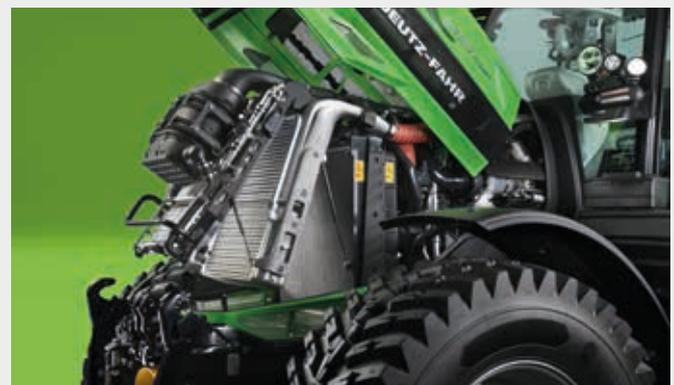
↑ Sistema de refrigeración en aluminio con palanca de acceso, accionable con una mano y filtro de aire Powercore con sistema de prelimpieza Cyclone opcional en los 6210 y 6230.
