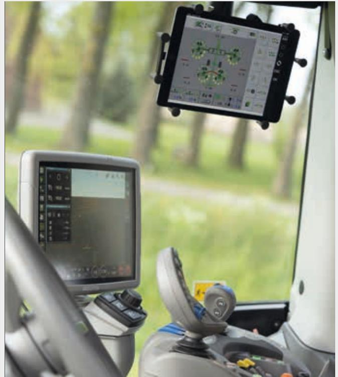
La función XTEND permite ver el SDF Guidance o controlar un implemento ISOBUS en un dispositivo externo como, por ejemplo, una tableta.
