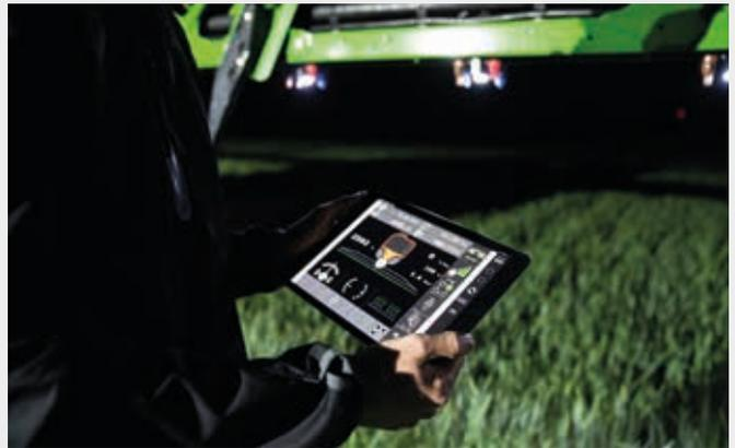
Con XTEND se pueden controlar los implementos con ISOBUS UT estando fuera de la cabina.
