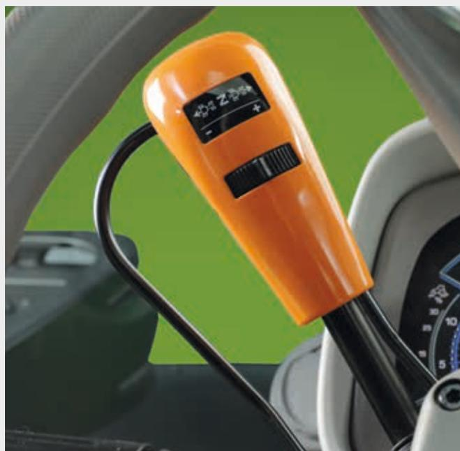
Palanca ergonómica del inversor con selector de ajuste SenseClutch.
