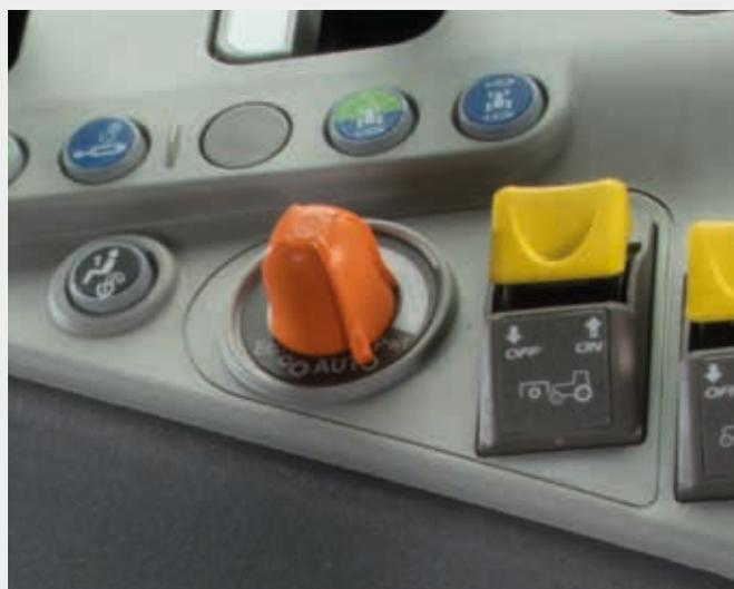
Fácil e intuitivo: con el selector de ajuste Eco/Power el operador puede cambiar el comportamiento del cambio APS (Automatic PowerShift).
