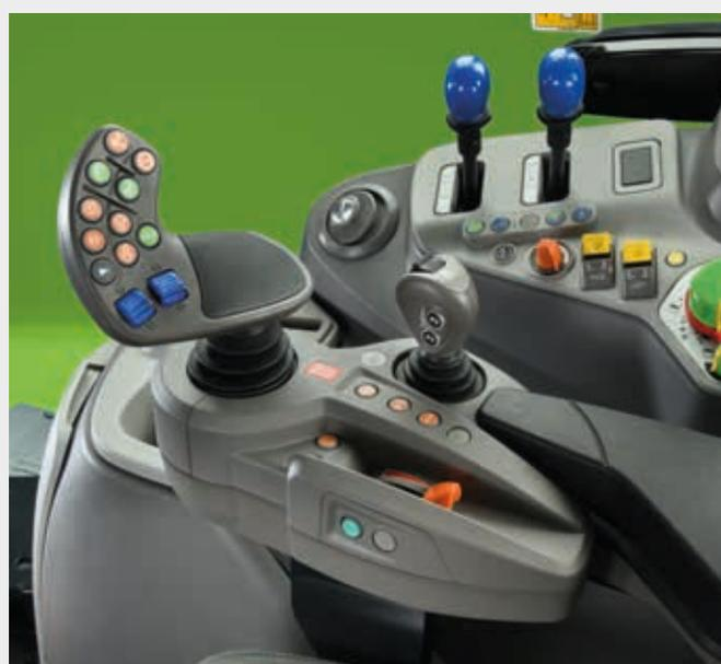
Las ruedecillas del joystick MaxCom y las dos palancas mecánicas controlan los distribuidores traseros, mientras que la palanca en cruz puede utilizarse para el cargador frontal.
