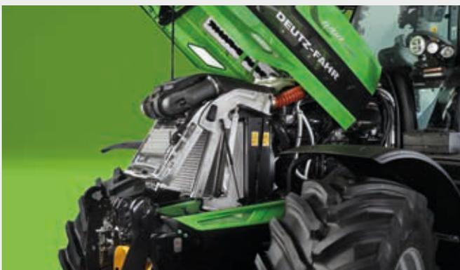
↑ Sistema de refrigeración en aluminio con palanca de acceso, accionable con una mano y filtro de aire Powercore con sistema de prelimpieza Cyclone en los 6160.4 - 6190.
