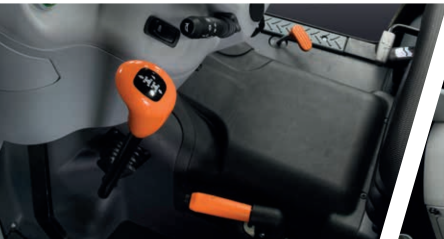
> Mechanische omkeerhendel op stuurkolom.
