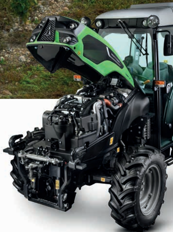
> Stage V conform via een eenvoudig EAT-systeem. AdBlue niet vereist.
