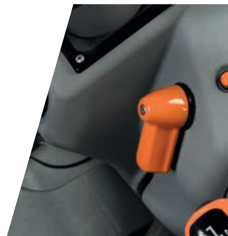
> Elektronische motortoerenregelaar met één motortoerental in het geheugen.
