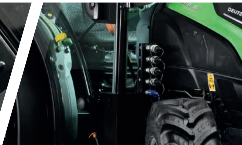
> Tot 4 midden gemonteerde hydraulische aansluitingen en 1 drukloze retour.
